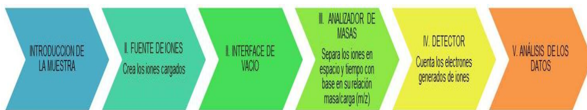
Ilustración 2. Etapas del proceso de GS/MS (tomada en base al Manual PerkinElmer).
