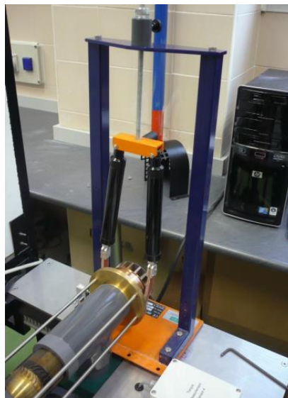
Figura 3. 24 Freno montado sobre turbina axial (Martínez, 2012).
