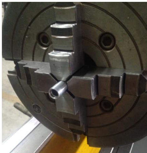
Figura 3. 21 Maquinado del conducto de entrada de vapor.
