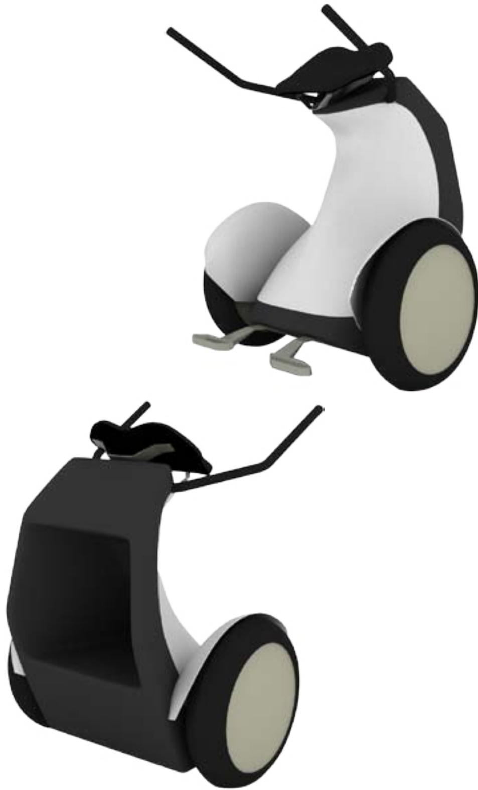
Fig. 8.6. Propuesta "Pingüino" con un cuerpo robusto y un área de carga trasera, esta idea sólo dio paso a la forma de la silueta que debían tener las demás propuestas, pero únicamente viéndola de perfil.
