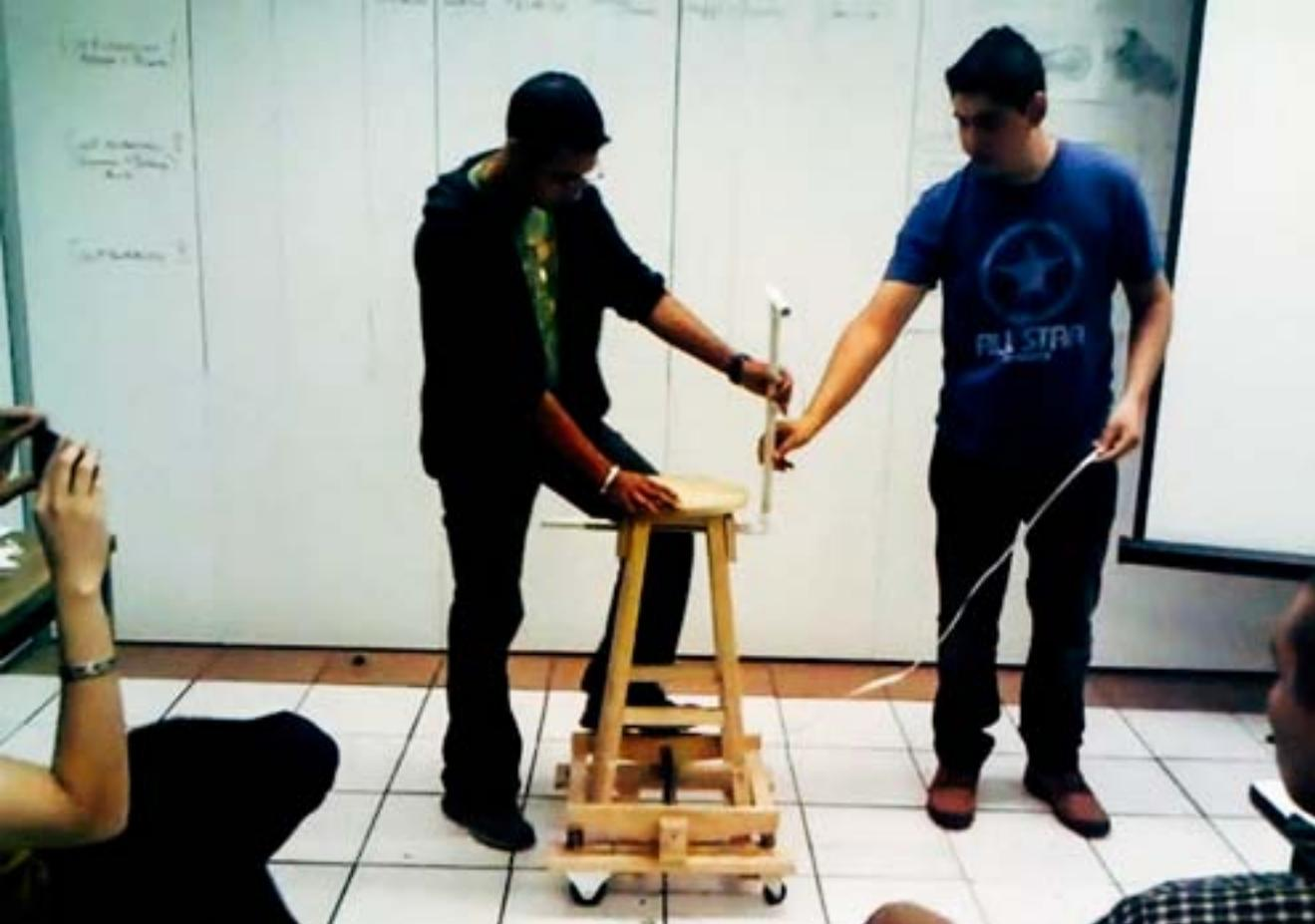
*Fig. 9.3 Simulador con manubrio al frente como el de una bicicleta, la desventaja de este manubrio era que con la inercia de la dirección en caso de caer el poste del manubrio atoraría a los usuarios y podría herir sus genitales fácilmente.*
