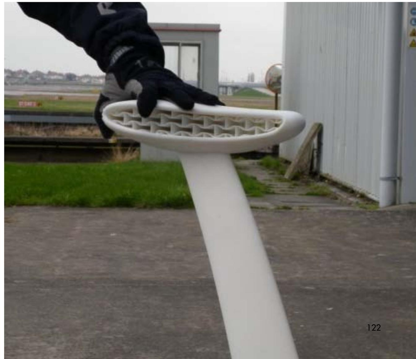
lados y para amortiguar dicho giro debía haber un material auxético (fig 12.8) como el de la bicicleta desarrollada por los Ingenieros británicos. Este tipo de material tiene un coeficiente de *Poisson* negativo lo que hace que cuando el material se tense aumente de tamaño y cuando se presione tenga un efecto contrario. Parecía pues que este tipo de material era una forma fácil de evitar elementos como amortiguadores u otro tipo de mecanismos.
