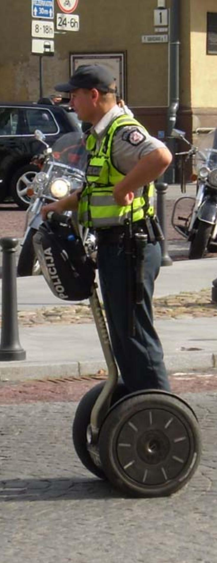
tiempo en que mantiene su peso fuera del eje principal. Para manejar y girar, el primer modelo de Segway tenía del lado izquierdo del manubrio un solo puño giratorio que el usuario giraría hacia adelante para ir a la derecha y hacia atrás si quería ir a la izquierda.
