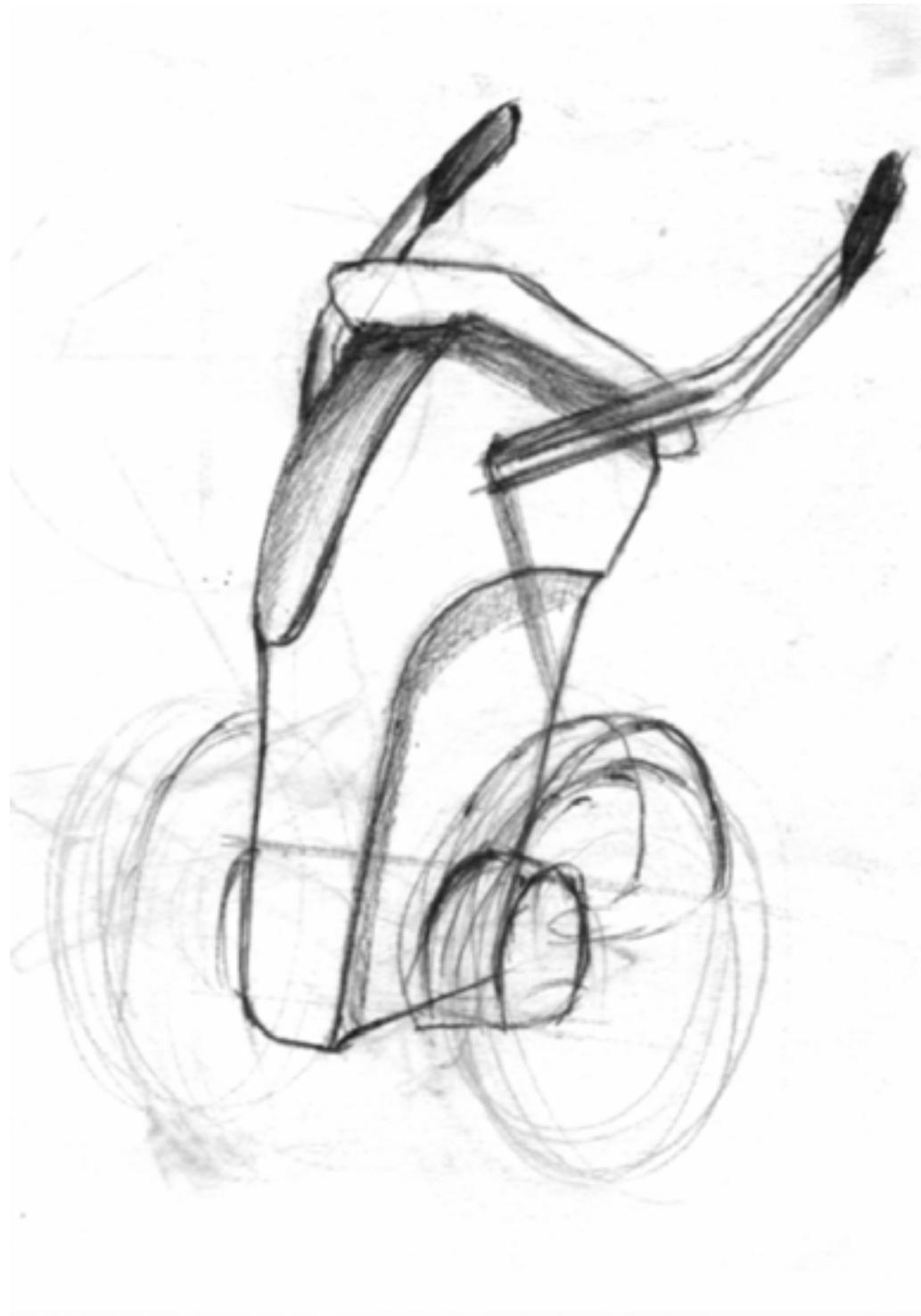
Fig 8.1. Boceto donde se planteaba un cuerpo sólido completo dónde se almacenaran todos los elementos electrónicos. El cuerpo aquí se dibuja delgado porque ya se había planteado algo más ancho que tenía un peso y una proporción visual muy pesado, pero la parte de los motores quedaba desconsiderada .
