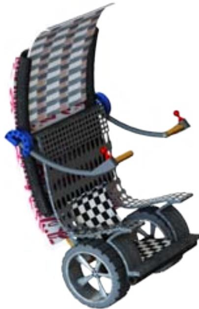
Fig. 2.9. La primer propuesta planteaba el uso de dos joysticks para manejar
