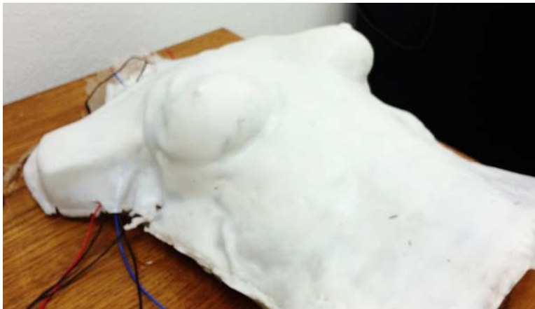
Figura 4.7: Modelo físico de Tórax Programable.
