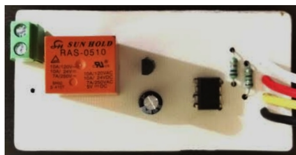
Figura 4.14: Módulo de potencia en físico para la alimentación del tórax.
