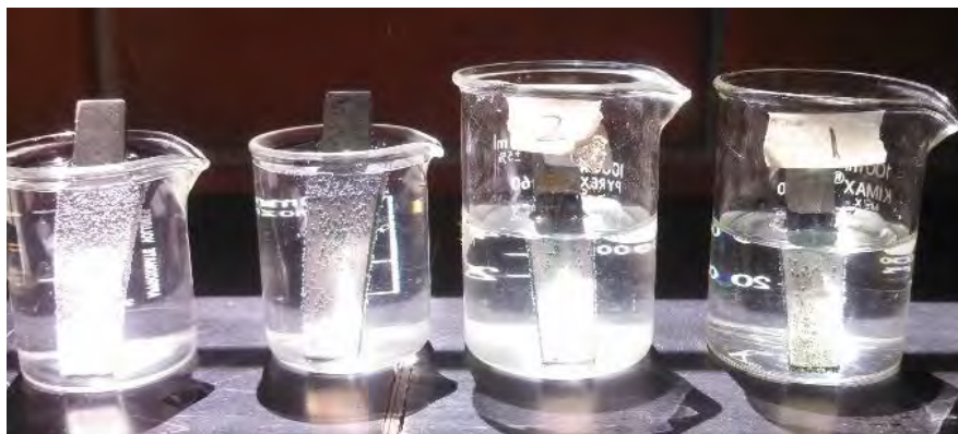
Figura 38. A la izquierda dos placas sin PANi y dos placas con PANi a la derecha, sometidas a una solución agresiva de H^+ y Cl^- durante dos horas.
