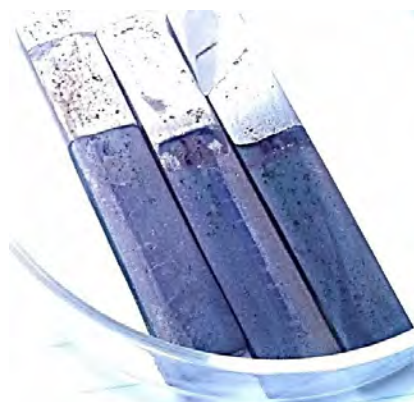
Figura 40. Placas con PANi de color azul después de la prueba de HCl 0.1M.
