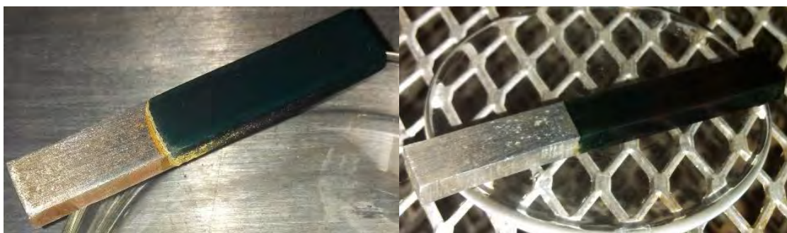
Figura 35. Placas de acero dulce (hierro) recubiertas con emeraldina, las cuales se obtuvieron a concentraciones de ácido oxálico 0.3 M y anilina 0.1 M durante 30 y 35 en electrosíntesis.
