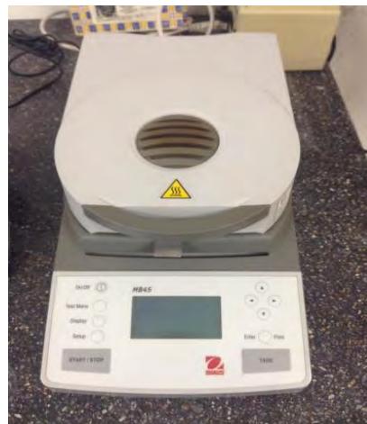
Figura 13. Termobalanza OHAUS MB45
