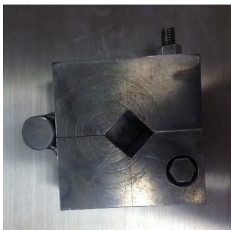
Figura 22. Vista superior de la matriz para confinación del polvo
