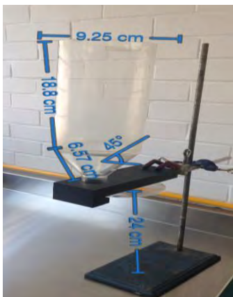
Figura 18. Dimensiones del flujómetro
