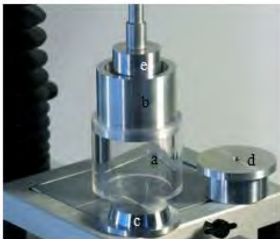
Figura 12. Dispositivo para medición de esfuerzo de cedencia no confinado
