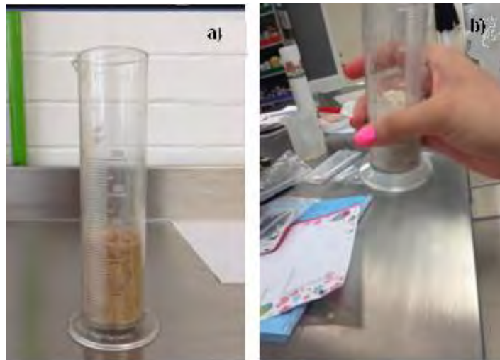
Figura 14. Medida de la densidad aparente y compactada. a) probeta llena con el material; b) golpeteo de la muestra para determinar la densidad compactada
