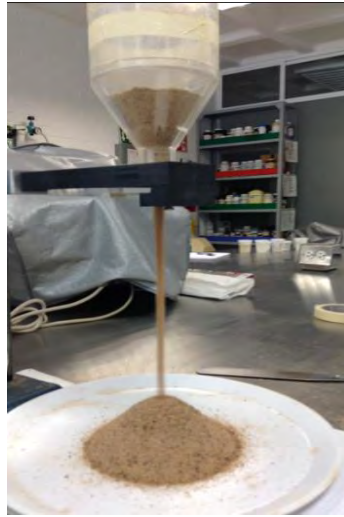
Figura 19. Material pasando a través del flujómetro
