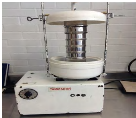
Figura 15. Agitador de tamices
