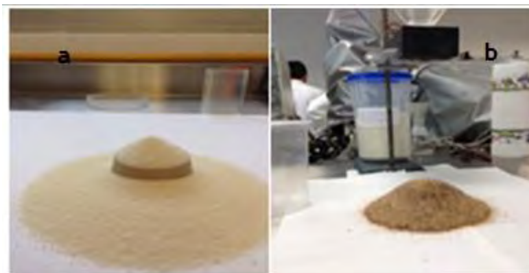
Figura 6. Ángulo de reposo. a) drenado y b) derramado
