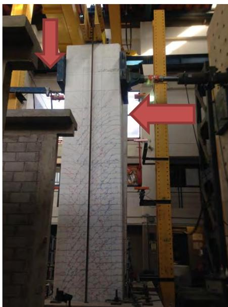
Figura 1.8 Posición del actuador durante las pruebas
