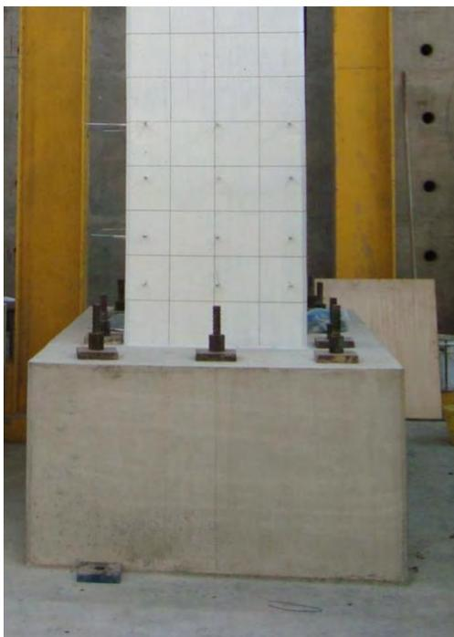
Figura 1.9 Anclaje utilizado en las pruebas
