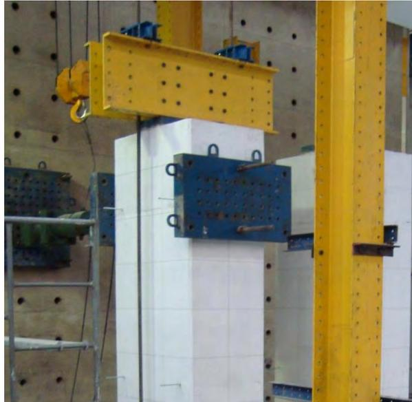
**Figura 1.10 Placas Metálicas en el cabezal**
