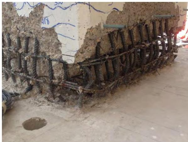
Figura 1.12 Falla de las varillas longitudinales por pandeo
