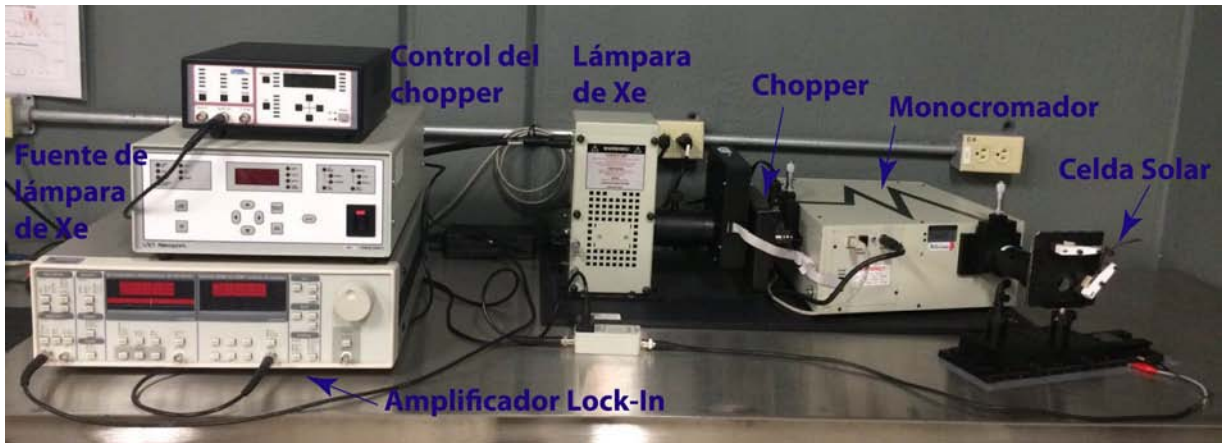
Figura 3.8. Equipo de medición de eficiencia cuántica externa de una celda solar.
