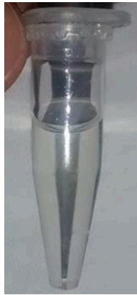
Figura 17. Fotografía de una muestra de microemulsión después de la prueba de centrifugación a 10mil rpm por 5 minutos.
