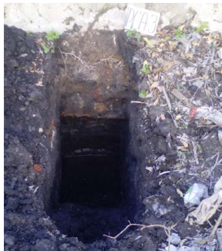
FIGURA No 7.- PERFIL ESTRATIGRÁFICO DE PCA-3
