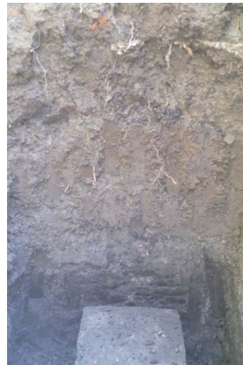
VISTA DE MUESTRA CUBICA INALTERADA OBTENIDA DEL POZO A CIELO ABIERTO No.2 Y MUESTRA REPRESENTATIVA ALTERADA EN LAS PAREDES DE EXCAVACION.
