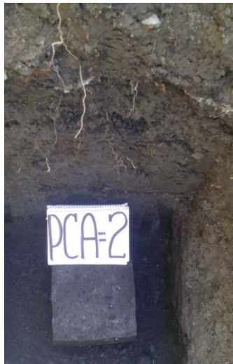
VISTA DE MUESTRA CUBICA INALTERADA OBTENIDA DEL POZO A CIELO ABIERTO No.2 Y MUESTRA REPRESENTATIVA ALTERADA EN LAS PAREDES DE EXCAVACION.
