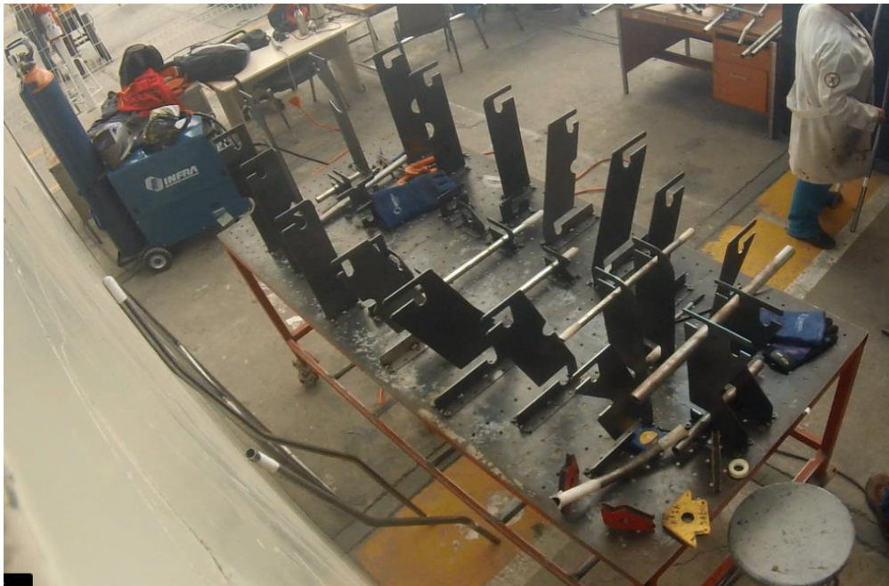
Figura 3.17 Montaje de los escantillones sobre la mesa de trabajo
