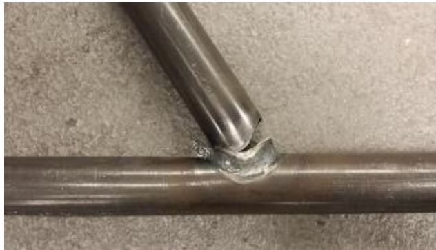
Figura 4.1 Prueba destructiva de soldadura
