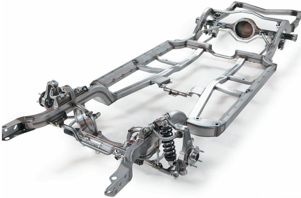
Figura 1.5 Representación del conjunto de sistemas conocido como “chassis” [15]
