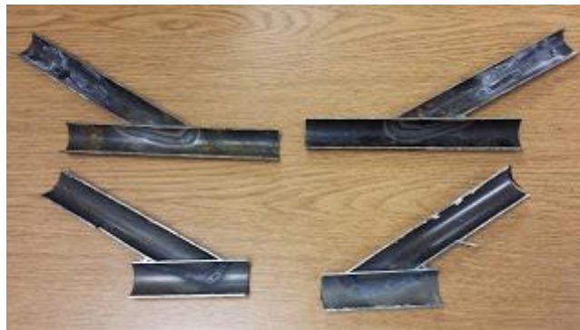
Figura 4.2 Prueba de inspección destructiva
