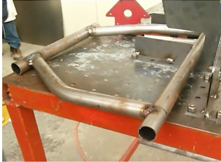
Figura 3.13 Dobleces implementados en miembros estructurales del chasis
