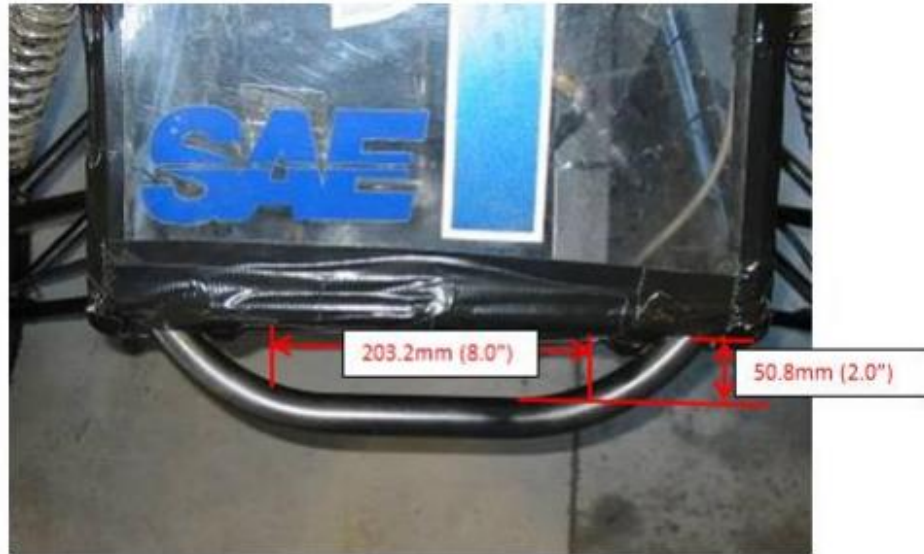
Figura 1.18 Especificaciones del anclaje delantero [8]
