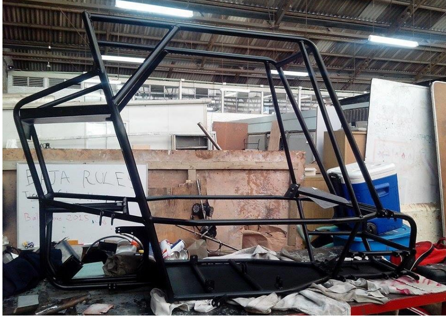
Figura 2.3 Geometría final del chasis del prototipo 2014
