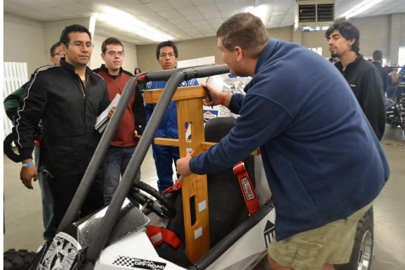
Figura 4.4 Prueba con el Template al chasis del prototipo 2013
