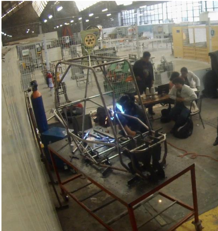
Figura 3.22 Finalización del proceso de soldadura del chasis
