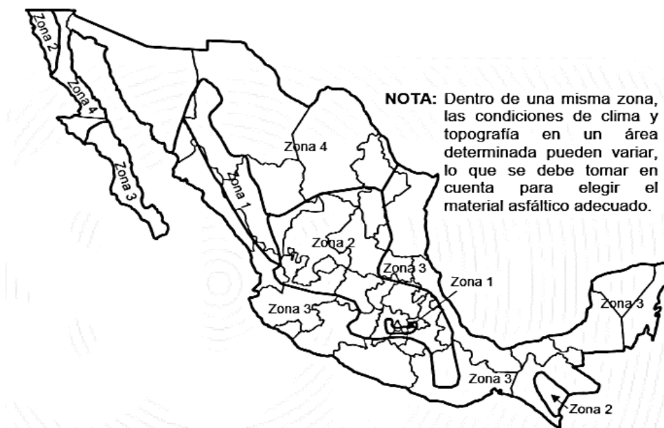
Figura 3.4.1 Regiones geográficas para la utilización de asfaltos clasificados según su viscosidad dinámica a 60°C. Fuente: SCT, Libro: características de los materiales. Parte 4. Materiales para pavimentos. Título 05. Materiales asfálticos, mezclas.
