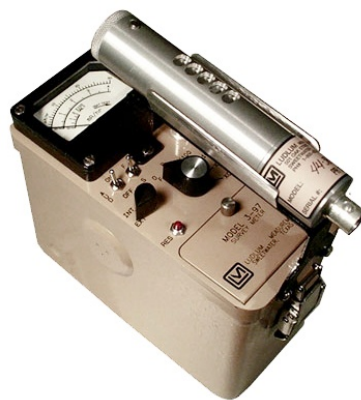
Figura 1.9: Prototipo de monitor de radiación con detector Geiger-Müller
