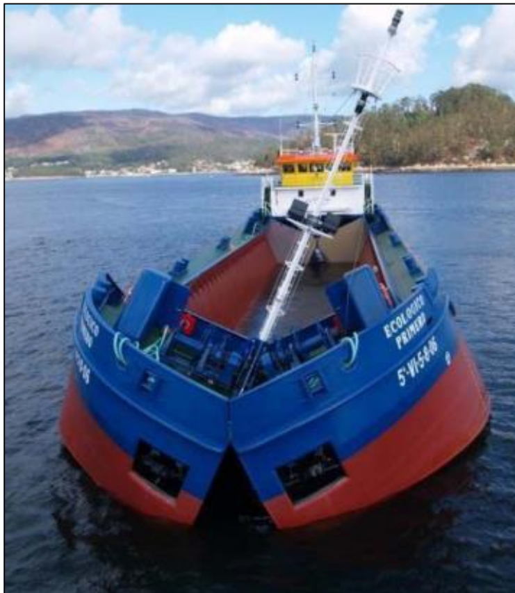
Figura 3.6 Embarcación para la colocación de los materiales
