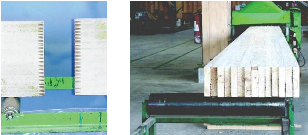
Ilustración 25. Corte "finger-joint" y encolado de las tablas por sus caras. Fuente: (Centro de Transferencia Tecnológica de la Madera, 2008).
