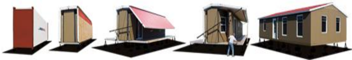
Ilustración 33. Proceso de despliegue: Sistema Habitaflex. Fuente: (Habitaflex, 2013).
