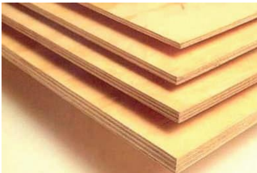
Ilustración 24. Contrachapados en diferentes espesores. Fuente: (Centro de Transferencia Tecnológica de la Madera, 2008).
