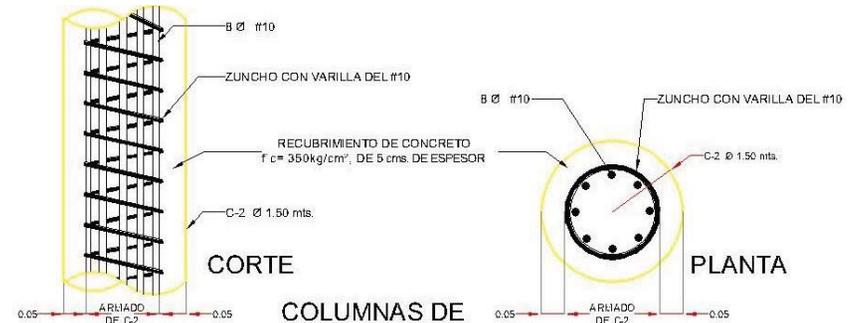
**COLUMNAS DE CONCRETO ARMADO**
