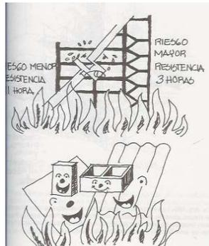
• **Artículo 119.-** Los elementos estructurales de acero de las edificaciones de riesgo mayor, deberán protegerse con elementos o recubrimientos de concreto, mampostería, yeso, cemento Pórtland, con arena ligera, perlita o vermiculita, aplicaciones a base de fibras minerales, pinturas retardantes al fuego u otros materiales aislantes que apruebe el Departamento, en los espesores necesarios para obtener los tiempos mínimos de resistencia al fuego, establecidos en el artículo anterior.
