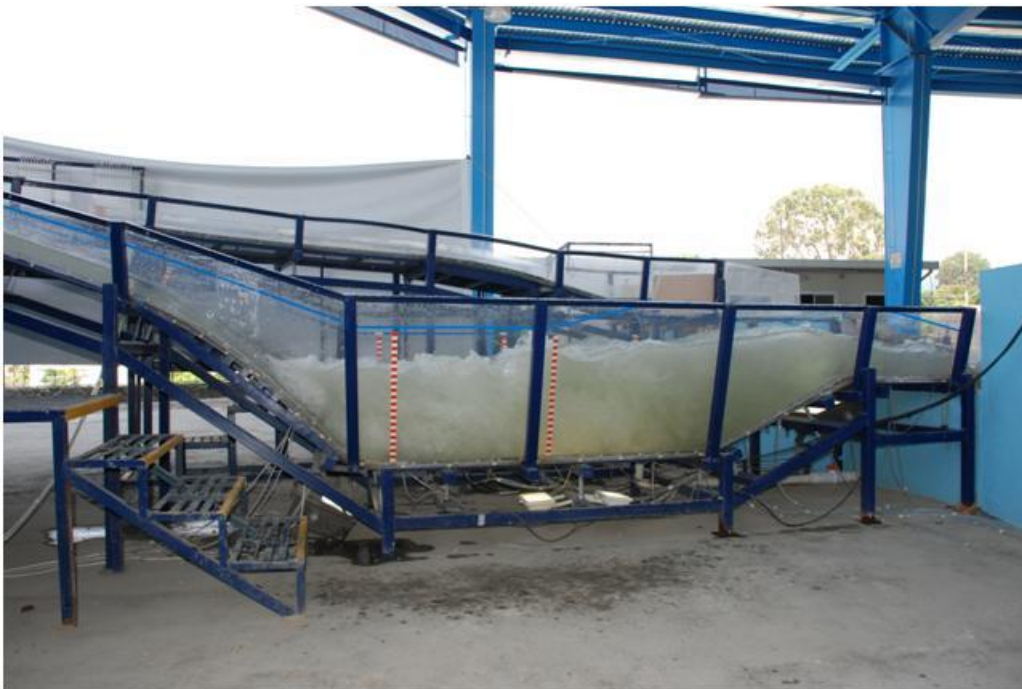
Figura 3.31 Perfil del flujo en el tanque amortiguador, Q=7\ 000\ \text{m}^3/\text{s}
