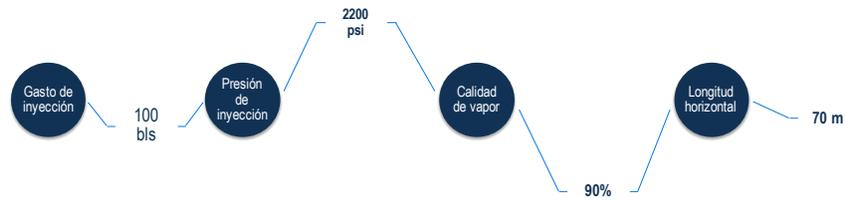
Al terminar el análisis de sensibilidad se pudo determinar que la longitud de los pozos horizontales es la variable que más incrementó la producción. Los gastos, la presión de inyección y la calidad de vapor son igual de importantes pues determinan la calidad de calor inyectada al fluido y así generar un cambio en la viscosidad y temperatura del hidrocarburo.
