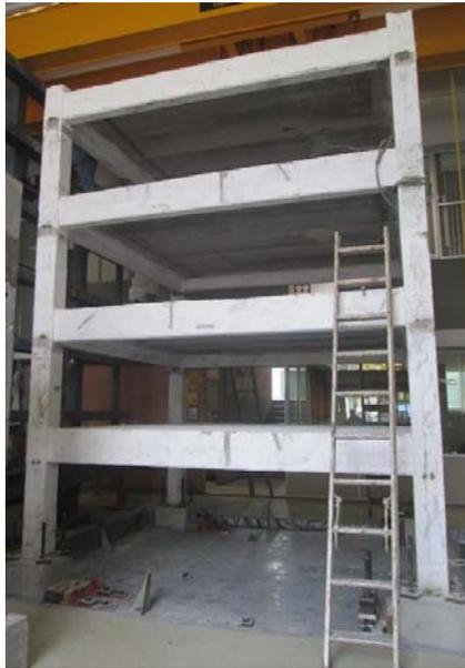
Figura 4.8 Modelo de edificio terminado
