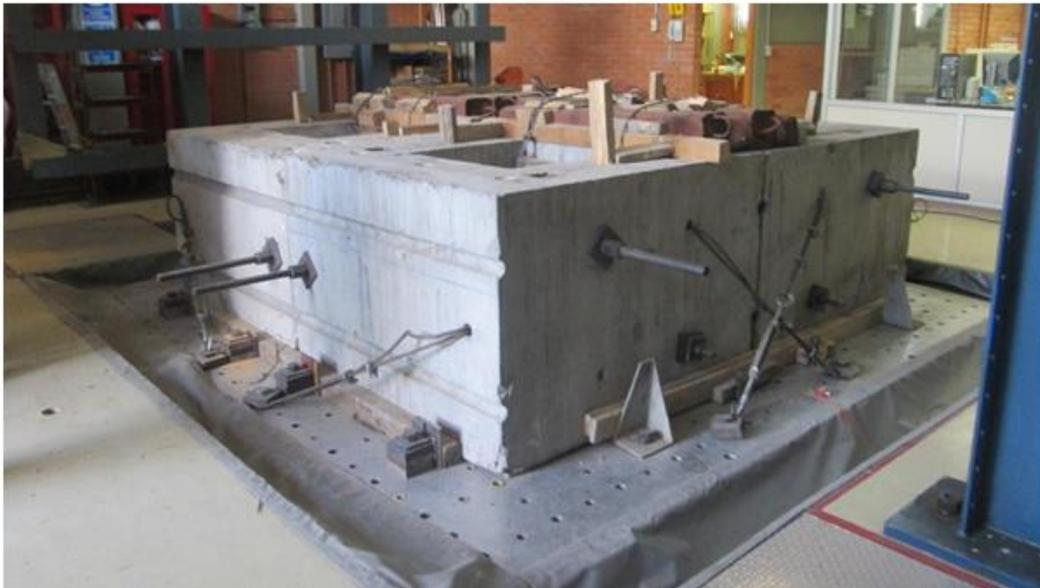
**Figura 5.1. Peso equivalente para calibración de mesa**
