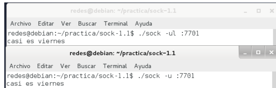
Figura No. 13. Comunicación entre terminales.
