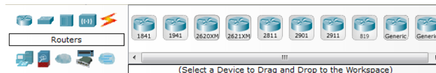
Figura No. 8. Secciones de dispositivos. A la izquierda grupos de dispositivos y a la derecha contenido del grupo de dispositivos.
