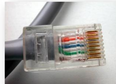
Figura No. 7. Cable de conexión finalizado.
