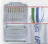
Figura No. 4 Distancia de corte de los alambres.
