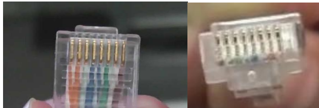
Figura No.5. Alambres y forro en el lugar adecuado dentro del conector
