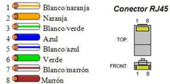
Figura No. 3. Configuración del cableado T568-B
