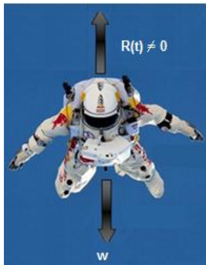
Figura 13. Diagrama de fuerzas involucradas en un cuerpo que cae siendo frenado por la resistencia del aire.
