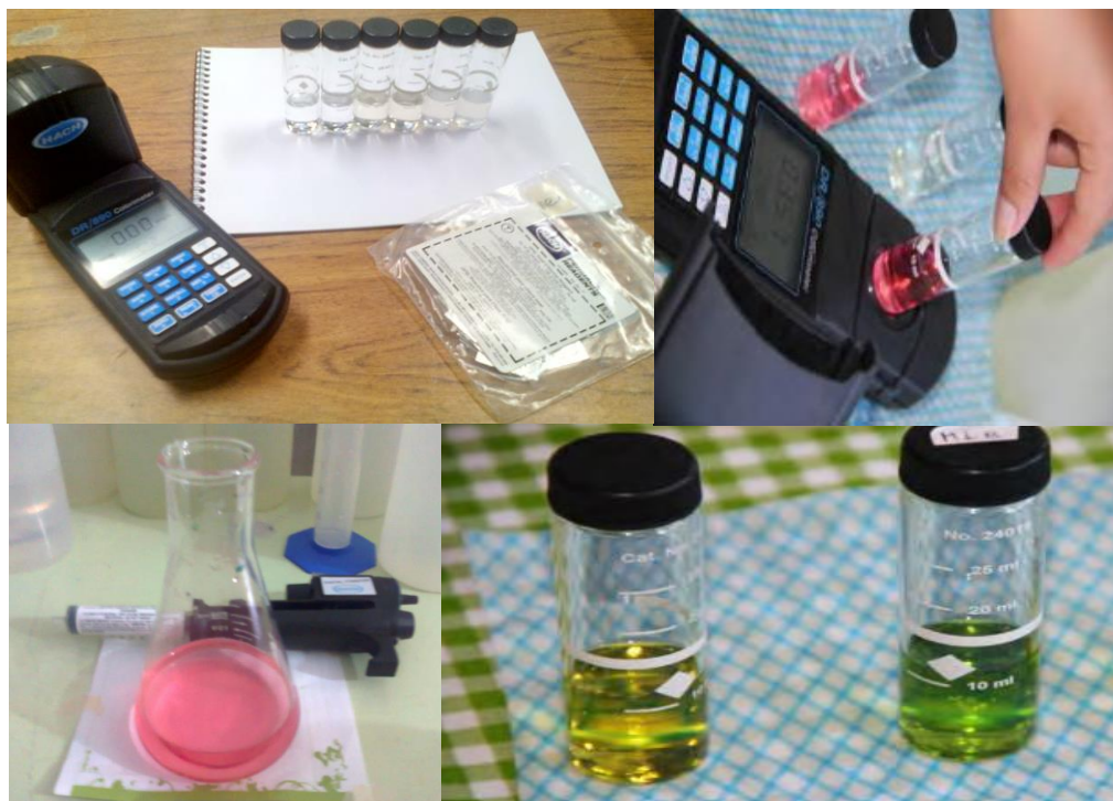
Figura 18. Determinación de la calidad del agua con equipo HACH DR/890
