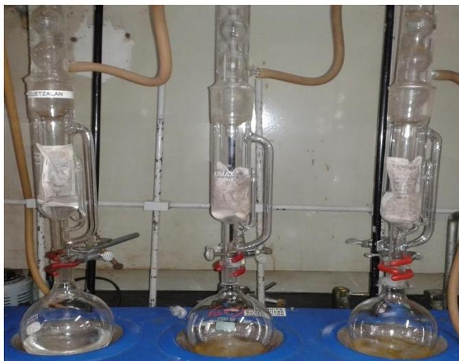
**Figura 2.** Extracción de aceite por el método de Soxhlet en las almendras residuales de mango ataulfo (*Mangifera indica L.*)
