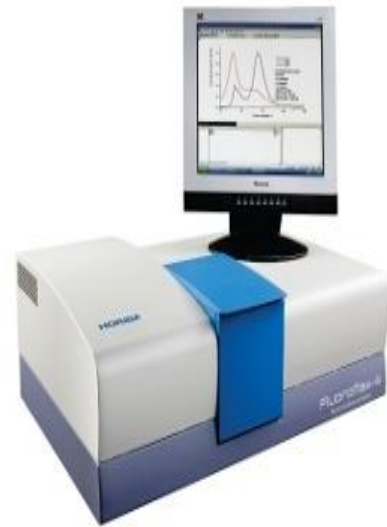
Figura 1.25 Esquema del espectrofotómetro de fluorescencia
