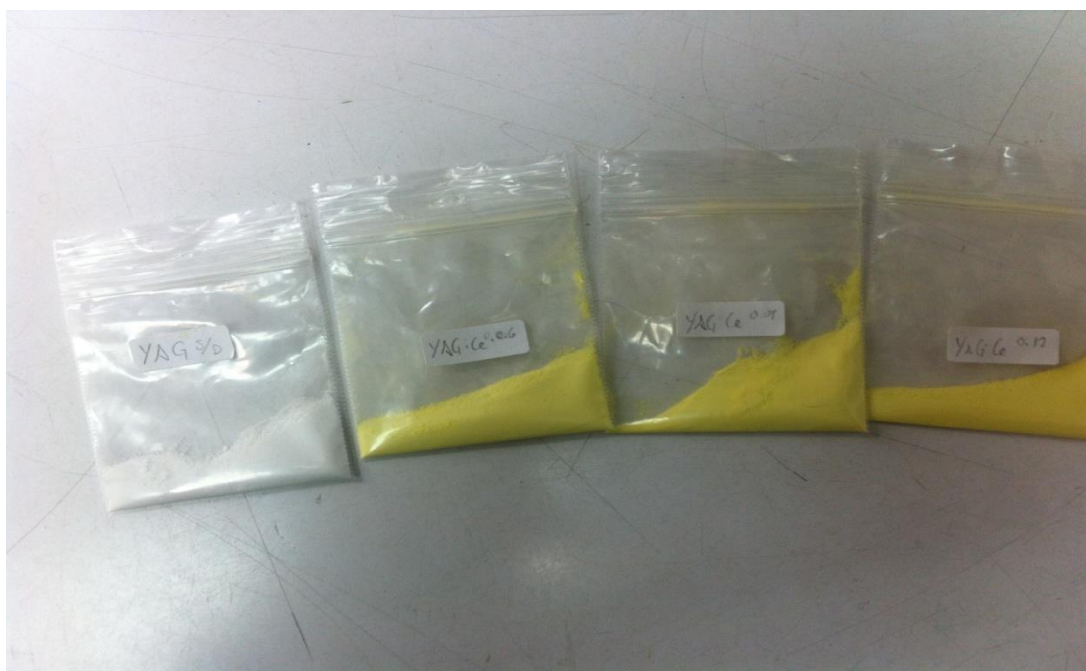
Figura 3.1. Compuestos de \text{Y}_3\text{Al}_5\text{O}_{12} , \text{Y}_{2.94}\text{Ce}_{0.06}\text{Al}_5\text{O}_{12} , \text{Y}_{2.91}\text{Ce}_{0.09}\text{Al}_5\text{O}_{12} , y \text{Y}_{2.88}\text{Ce}_{0.12}\text{Al}_5\text{O}_{12} (de izquierda a derecha)
