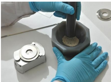
Figura 1.21 Molienda de la muestra para su posterior análisis
