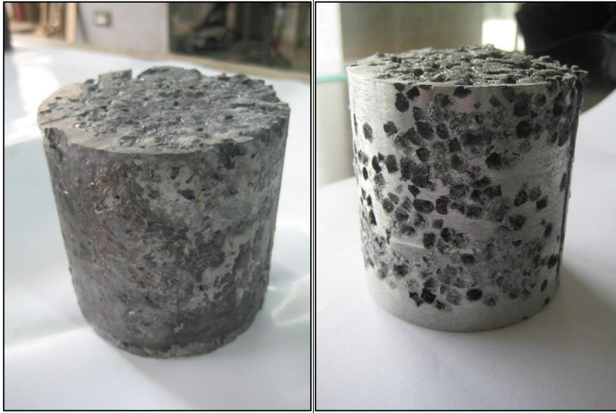
Figura 59.- Espuma metálica resultado del proceso antes y después de ser removida la capa superficial de Al.
