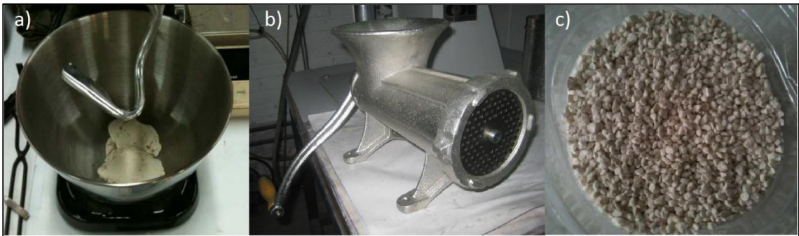
Figura 25.- a) Proceso de mezclado b) Extrusor utilizado c) Partículas después de tratamiento de secado.
