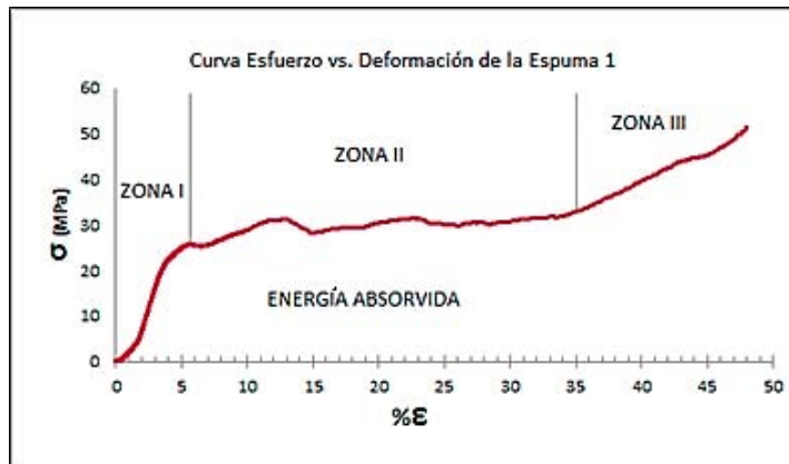
Figura 63.- Curva esfuerzo- deformación de la probeta 1 donde se describen las diferentes zonas típicas del comportamiento de materiales celulares.
