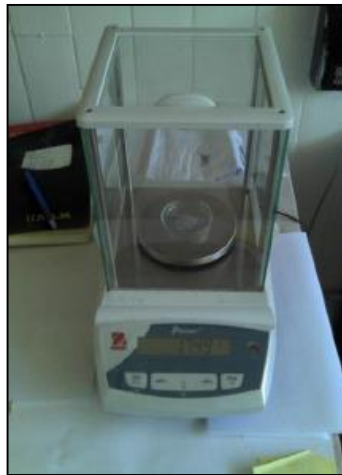
Figura 32.- Balanza analítica marca Ohaus, modelo Pioneer utilizada para la obtención de los pesos de las probetas de espuma de Al, así como los compuestos de la preforma para fabricarlas.
