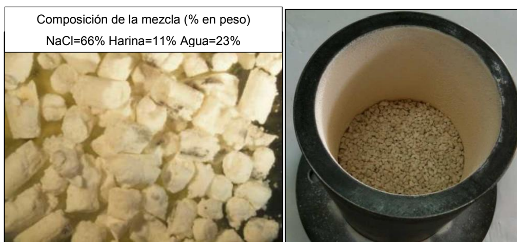
Figura 54.- Partículas obtenidas para la fabricación de la preforma y reactor con las partículas ya colocadas.
