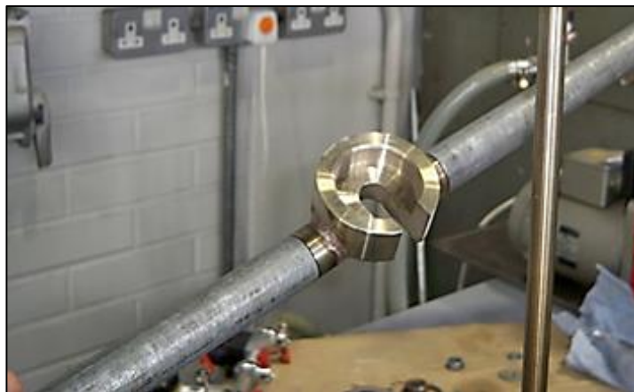
Figura 50.- Herramienta (gancho) para remover e introducir el reactor al horno.
