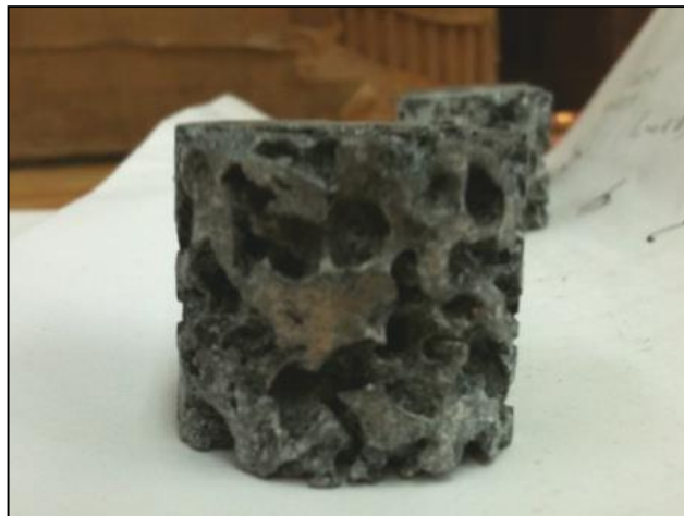
Figura 31.- Una de las probetas después de ser removidos completamente los residuos de la preforma.
