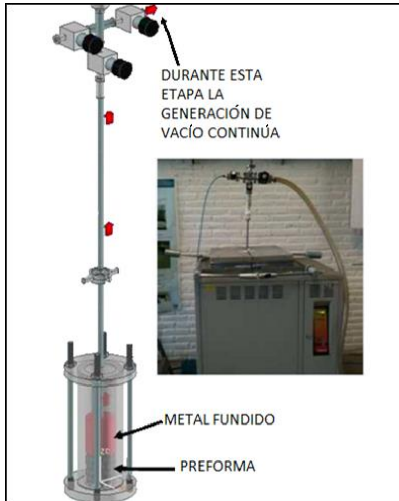
Figura 27.- Esquema representativo de la etapa de fusión.
