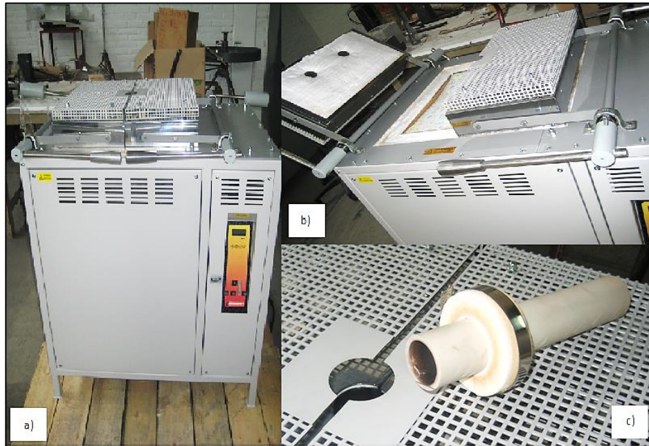
Figura 51.- a) Horno, b) Horno abierto, c) Lanceta-tapón y tapa con orificio.
