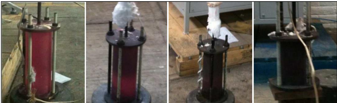
Figura 29.- Reactor en diferentes etapas de enfriamiento, con la implementación de la placa de cobre para enfriamiento acelerado desde la parte inferior del reactor.
