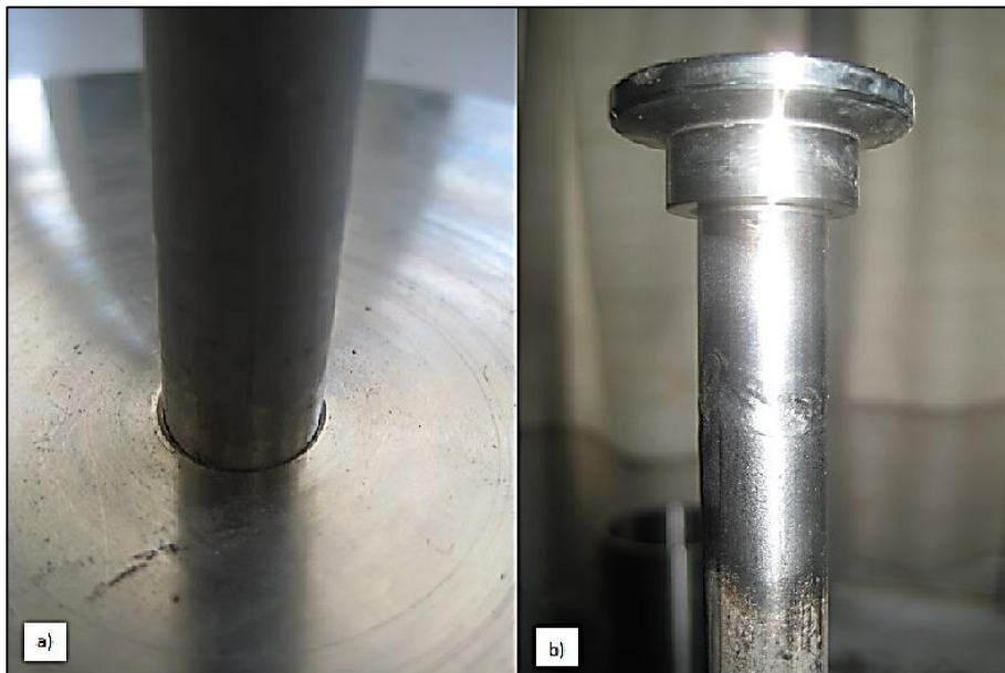
Figura 45.- a) Soldadura de la tapa superior con el tubo de entrada y salida de gases, b) Soldadura de la boquilla al final del tubo de entrada y salida de gases.
