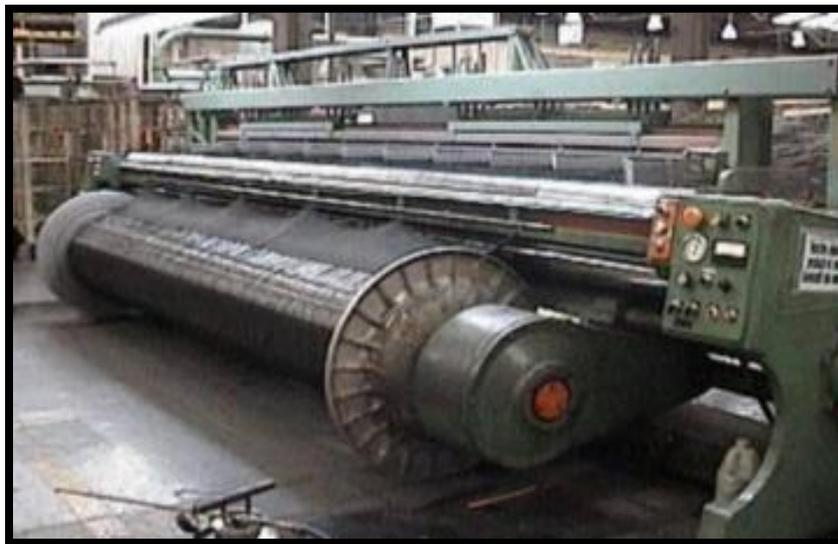
Imagen II.6. Proceso de fabricación de geosintéticos tejidos en un telar
