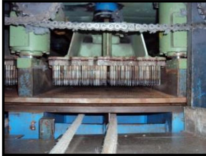
Imagen II.10. Máquina punzonadora para entrelazar las fibras del geosintético
