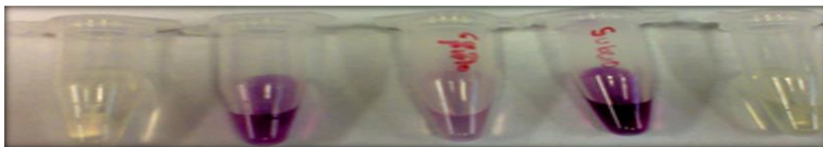
Figura 11. Prueba de alcaloides con p -dimetilaminobenzaldehído. El agua y un esteroide dan una prueba negativa (sin cambio de coloración). El triptófano, el extracto metanólico y la fracción 1, dan una prueba positiva (cambio de coloración).
