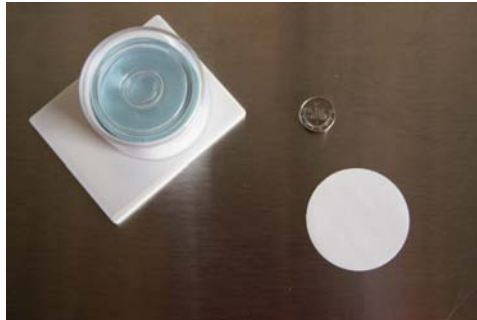
Figura 35: Estuche con membranas de Nylon de 45mm de diámetro y un ejemplar de muestra fuera de la caja. Una moneda de 50 centavos ha sido colocada como referencia.
