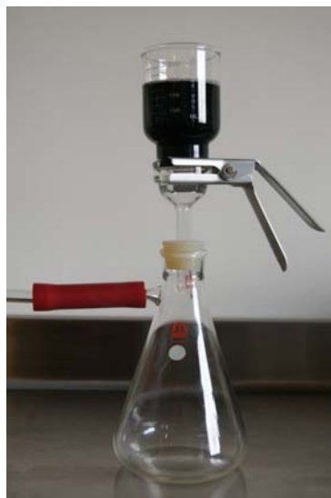
Figura 36: Sistema de filtración de Buckypaper. La suspensión de nanotubos se filtra al vacío a través de una membrana de Nylon soportada sobre un embudo plano de vidrio esmerilado.
