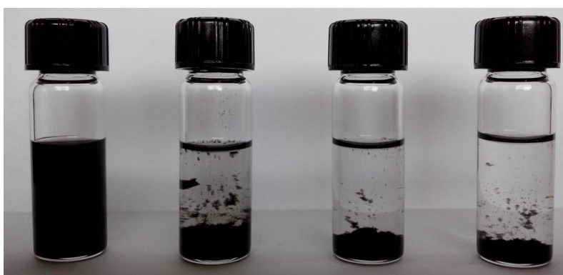
Figura 40: De izquierda a derecha, Buckypaper prístino, Buckypaper con AP, DAN y ODA en isopropanol tras 10 minutos de aplicación de ultrasonido.
