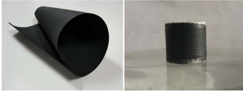
Figura 27: Izquierda: Un pliego de Buckypaper de MWCNT's fabricado por NanoTechLabs. Inc. Derecha: Una Buckycolumn obtenida por compresión de Frit (véase la sección 1.4.2), se pueden apreciar los émbolos de polipropileno en los extremos.
