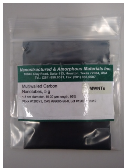
Figura 22: Paquete de 5g de MWCNT's fabricados por Nanostructured & Amorphous Materials Inc. Las especificaciones pueden leerse en el empaque. [45]
