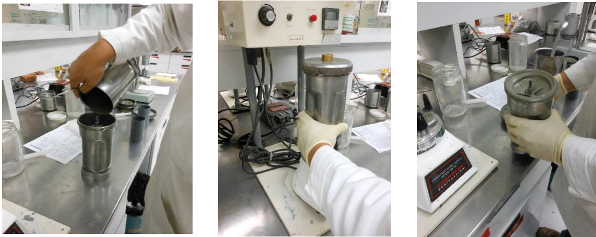
FIGURA 141. CÁLCULO DEL VOLUMEN DE LECHADA Y DE SU MASA CUANDO SE CONOCE LA DENSIDAD DE LECHADA ESPUMADA
