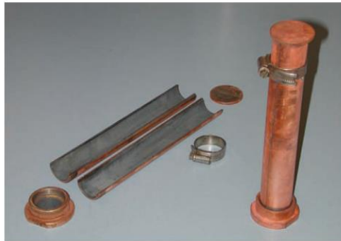
FIGURA 179. DISPOSITIVO PARA EL FRAGUADO DE UNA MUESTRA DE LECHADA ESPUMADA PARA POSTERIORMENTE DETERMINAR LA PERMEABILIDAD DE LA MISMA.
