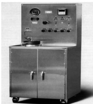
FIGURA 120. EQUIPO DE CÁMARA DE CURADO CONSISTÓMETRO HP-HT
