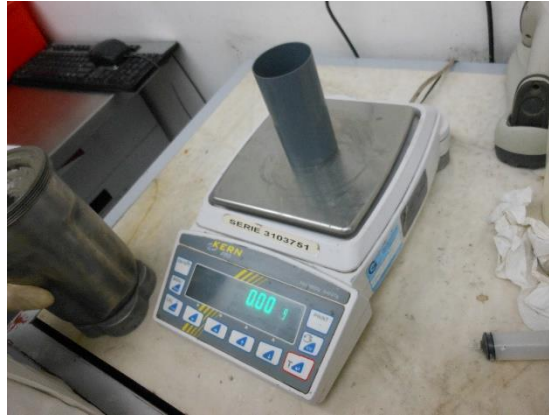
FIGURA 156. RECIPIENTE PARA LA DETERMINACIÓN DE LA DENSIDAD DE UNA LECHADA ESPUMADA
