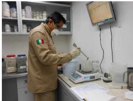
FIGURA 134. PESADO DEL CEMENTO Y DE LOS AGENTES ESPUMANTES
