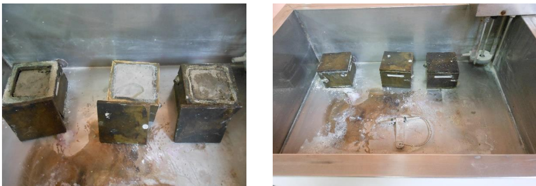
FIGURA 176. MOLDES PARA LA PRUEBA DE RESISTENCIA AL ESFUERZO COMPRESIVO EN UNA LECHADA ESPUMADA.
