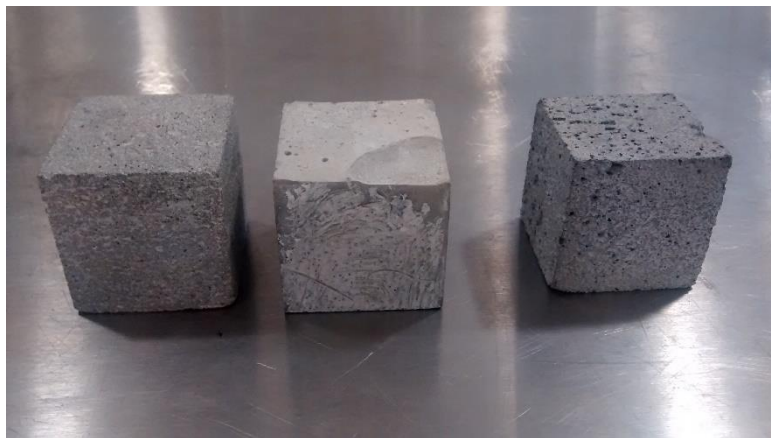
FIGURA 178. MUESTRAS DE CUBOS FRAGUADOS DE LECHADAS ESPUMADAS A DIFERENTE DENSIDAD, LISTAS PARA COMPROBAR SU ESFUERZO COMPRESIVO.
