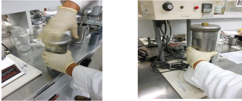
FIGURA 153. SELLADO DEL VASO DE MEZCLADO Y GENERACIÓN DE LA LECHADA DE CEMENTO ESPUMADO
