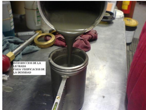
FIGURA 96. BALANZA DE LODOS PRESURIZADA CON BOMBA DE CILINDRO PISTÓN (ANTES DE PRESURIZAR CON EL MISMO FLUIDO)
