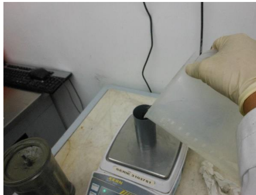
FIGURA 149. OBTENCIÓN Y MEDICIÓN DE LA TEMPERATURA DEL AGUA DE MEZCLA
