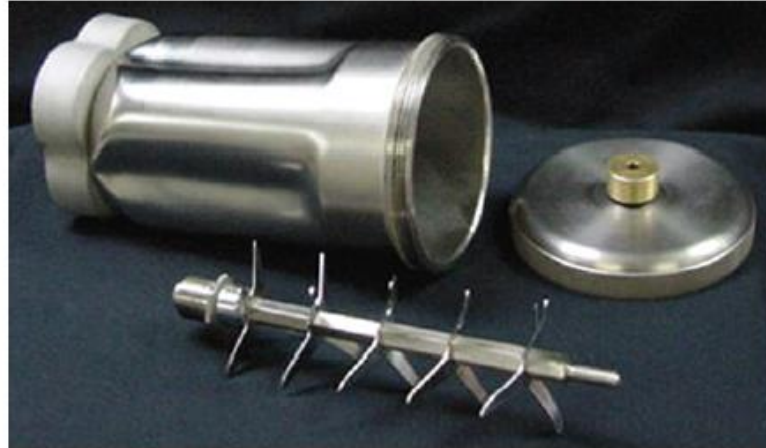
FIGURA 144. RECIPIENTE DE MEZCLA Y MONTAJE DE CUCHILLAS MÚLTIPLES. CONJUNTO MULTI-CUCHILLA (STACKED-BLADE).
