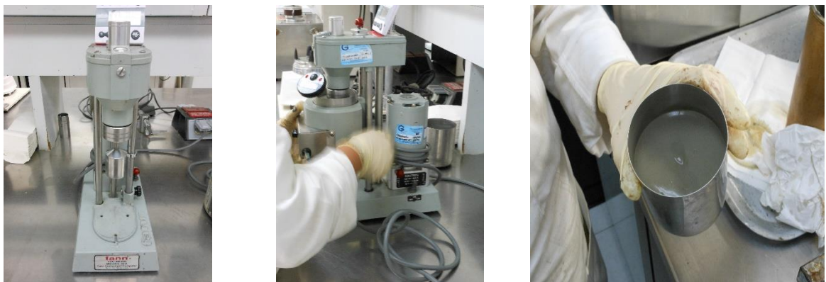
FIGURA 185. VISCOSÍMETRO ROTACIONAL FANN 35-A EQUIPO PARA EL DESARROLLO DE LA PRUEBA DE COMPORTAMIENTO REOLÓGICO DE UNA LECHADA.
