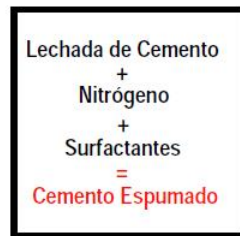
FIGURA 125. DEFINICIÓN Y MUESTRA DE UNA LECHADA DE CEMENTO ESPUMADO
