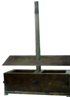
FIGURA 116. MOLDES CÚBICOS CON CUBRE PLACAS
