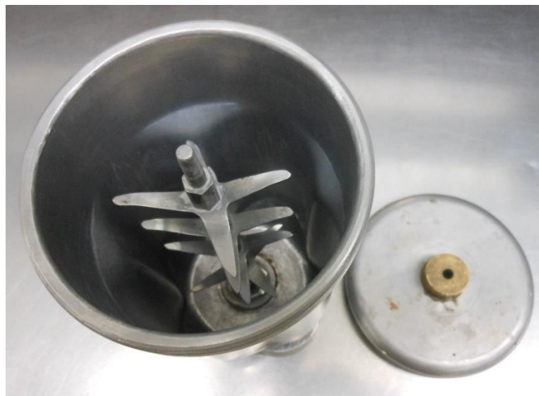
FIGURA 143. VASO DE MEZCLADO ESPECIAL PARA LA ELABORACIÓN DE LECHADAS ESPUMADAS
