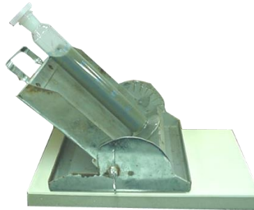
FIGURA 124. PROBETA A 45° PARA PRUEBAS DE AGUA LIBRE EN POZOS DESVIADOS O INCLINADOS
