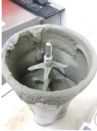
FIGURA 155. GENERACIÓN DE UNA LECHADA DE CEMENTO ESPUMADO
