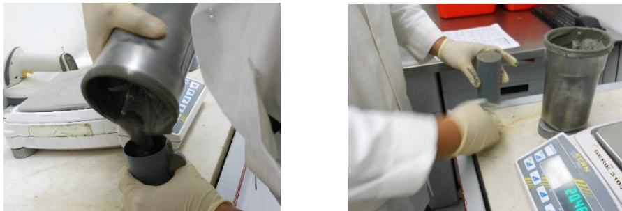
FIGURA 157. VACEADO DE LA LECHADA ESPUMADA EN EL RECIPIENTE DE DENSIDAD
