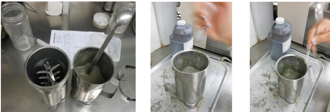
FIGURA 139. DETERMINACIÓN DE LA LECHADA DE DISEÑO ANTES DE SER ESPUMADA
