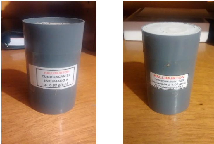
FIGURA 160. MUESTRAS DE LECHADAS DE CEMENTO FRAGUADAS Y MEDIDAS EN SU DENSIDAD.
