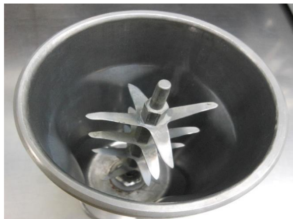
FIGURA 145. CONJUNTO DE HOJAS O CUCHILLAS SIMPLES (DE CONFORMIDAD CON LA NORMA ISO 10426-2:2003, CLÁUSULA 5.)
