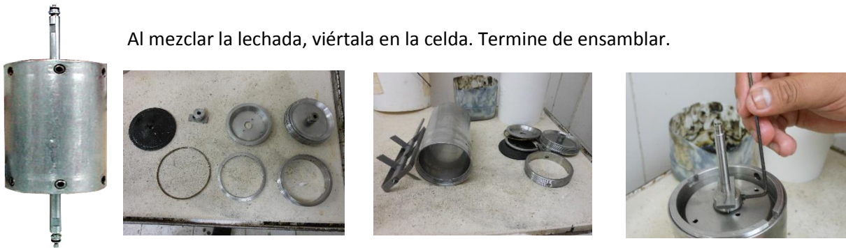
FIGURA 161. ENSAMBLADO Y MONTAJE DE LA CELDA BP DE UN CONSISTÓMETRO HP-HT
