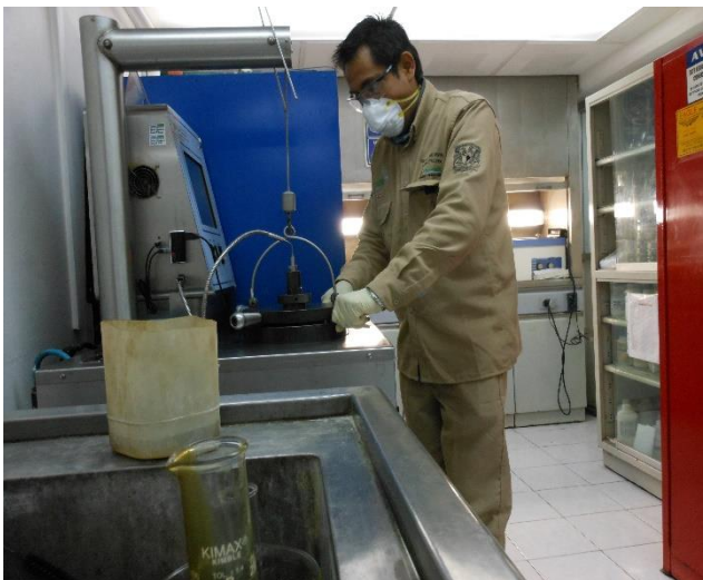
FIGURA 181. CONSISTÓMETRO DE ALTA PRESIÓN Y ALTA TEMPERATURA PARA LA DETERMINACIÓN DEL TIEMPO DE ESPESAMIENTO EN UNA LECHADA ESPUMADA.
