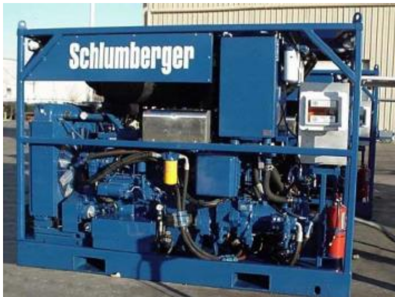
FIGURA 196. REQUERIMIENTOS DEL EQUIPO DE CEMENTACIÓN ESPUMADA (BOMBA DE N2)
