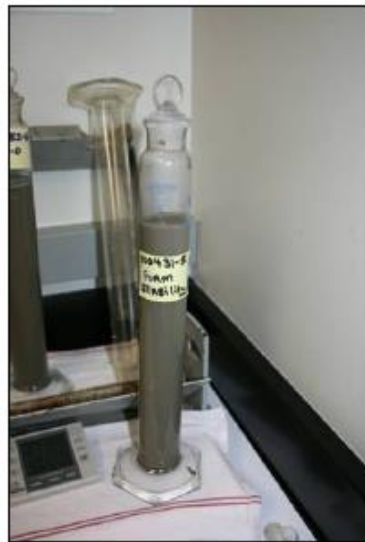
FIGURA 174. MUESTRA DE INESTABILIDAD EN UNA LECHADA ESPUMADA
