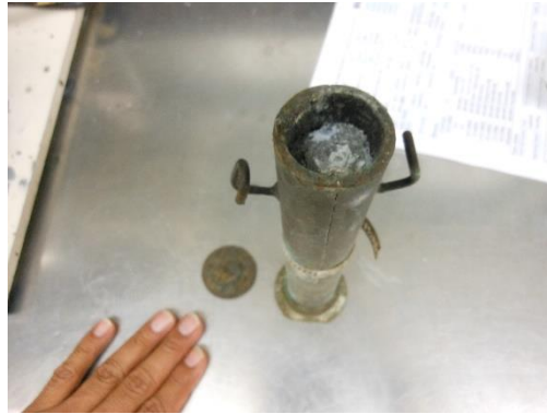
FIGURA 170. LECHADA FRAGUADA PARA DETERMINACIÓN DE SU ESTABILIDAD
