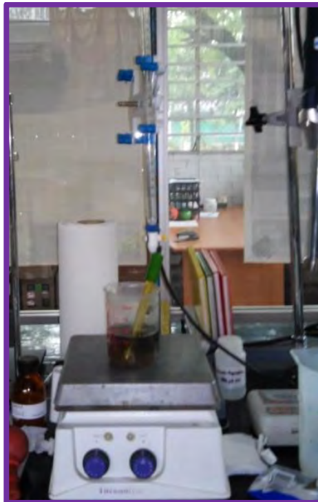
Figura 21. Medición del pH en las muestras de vino.
