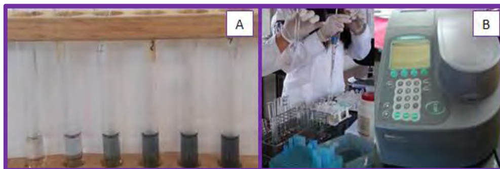
Figura 16. Determinación de compuestos fenólicos. (A) Curva patrón con solución de ácido gálico y (B) Espectrofotómetro (Marca Thermo Spectronic).
