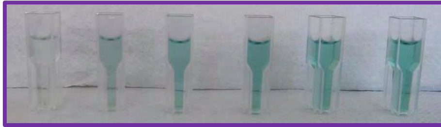
Figura 19. Curva patrón a distintas concentraciones (0, 300, 240, 180, 120 y 60 mM) de una solución madre del antioxidante estándar Trolox (4Mm (1mg/1mL).
