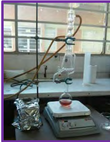
Figura 23. Destilación del vino para su posterior valoración con NaOH.
