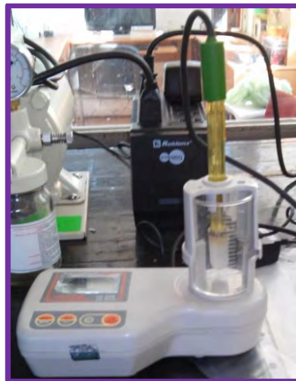
Figura 20 . Potenciómetro utilizado para la medición del pH del vino.
