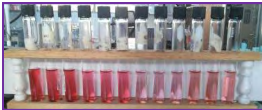
Figura 17. Tubos de ensayo para la identificación de antocianos.
