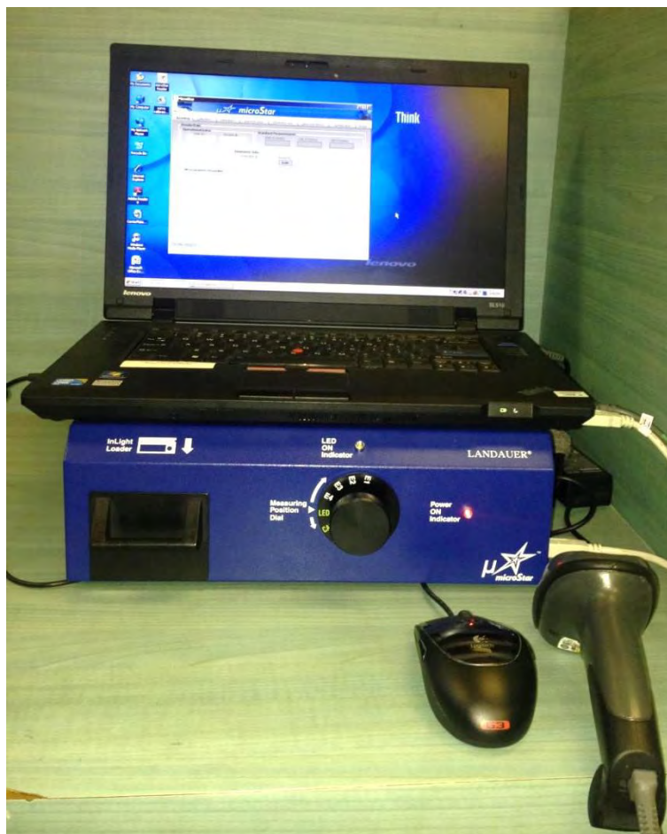
Ilustración 9. Equipo de software Microstar® Reader para lectura de los dosímetros de tecnología OSL.
