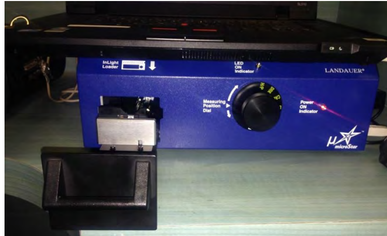
Ilustración 12. Vista del equipo de software antes de asegurar la lectura del dosímetro.
