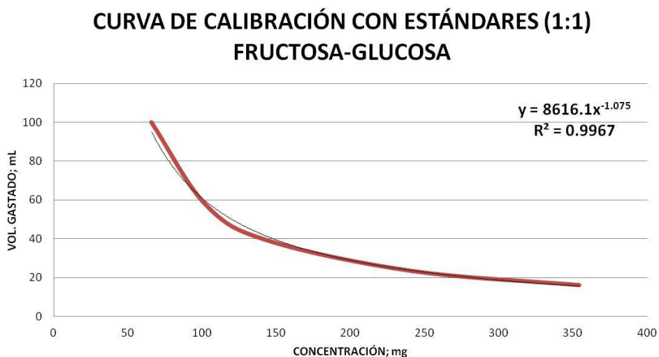
Gráfica A1. Curva de calibración para determinar concentración de azúcares reductores en jugos de caña con patrones de D-(+)-Glucosa y D-(-)-Fructosa.
