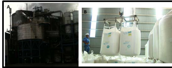
Figura 4. Etapas finales de producción de azúcar; A) Región del ingenio donde ocurren procesos de clarificación, condensación y cristalización de sacarosa. B) Empacado de cristales de azúcar.
