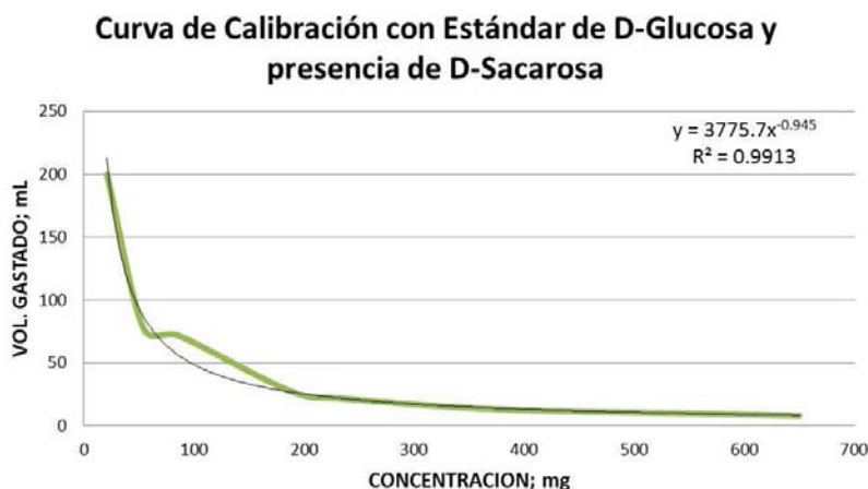
Gráfica A3. Curva de calibración para determinar concentración de azúcares reductores en jugos de caña utilizando patrón de D-(+)-Glucosa mezclado con D-(+)-Sacarosa.
