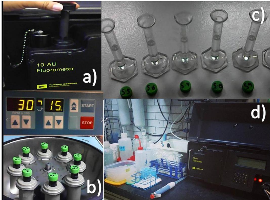
**Figura 7.** Lectura fluorométrica: a) calibración mediante estándar secundario de clorofila "a", b) centrifugado de las muestras, c) medición del volumen extraído después de la centrifugación d) equipo de disoluciones para realizar lectura de fluorescencia (micropipetas y probetas), y TD 10 AU en función.
