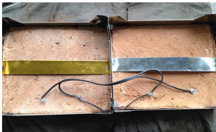
Figura 3. 6 - Arreglo en Paralelo.
