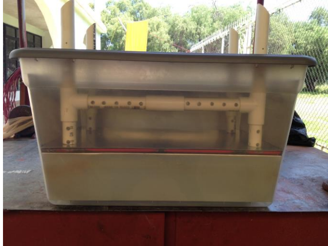
Figura 4. 7 - Armado Completo del Contenedor.
