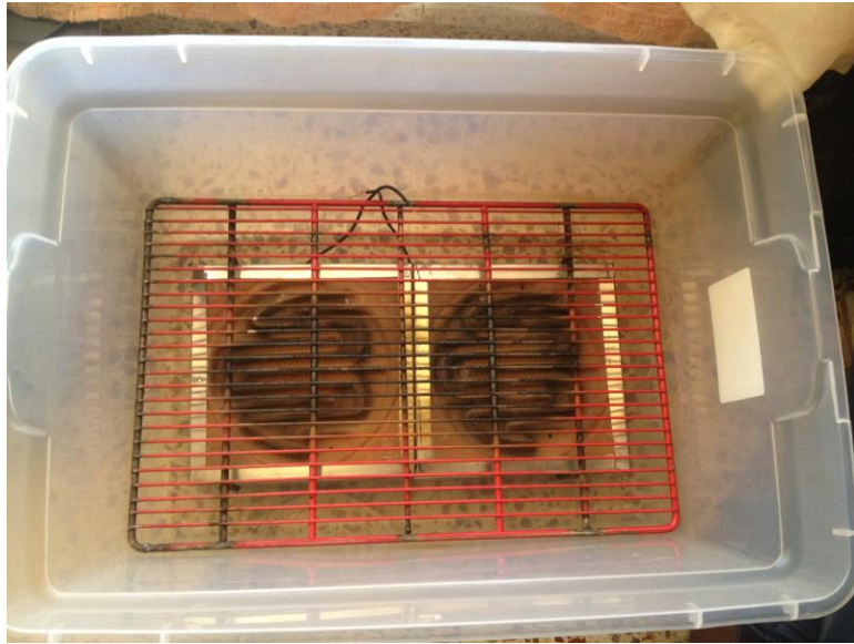
Figura 3. 10 - Instalación de los Calentadores.
