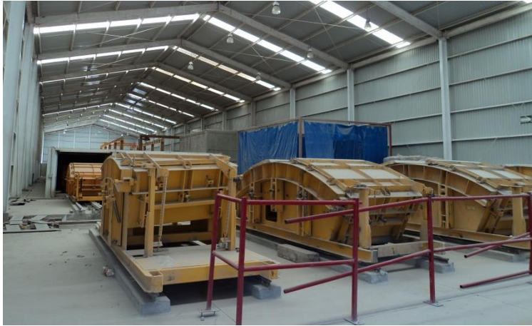
Figura 5.9 Fabricación de dovelas.
