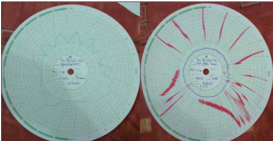
Figura 5.13 Pozo Arcabuz 576, la Estimulación de la Válvula de Seguridad Empieza a Tener Efecto en el Comportamiento del Pozo 24
