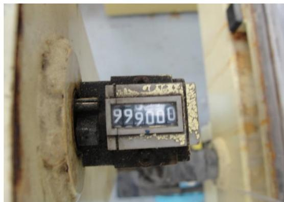
**Figura 2.26** Contador numérico de la pendiente.
