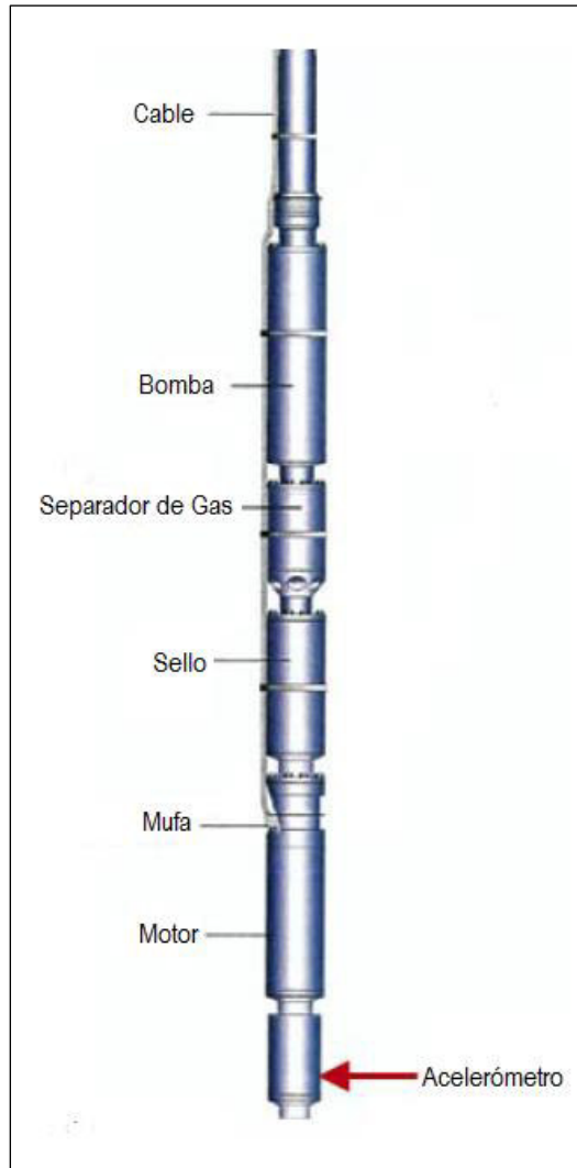
Figura 4.14 – Esquema de la Ubicación del Acelerómetro en el Sistema BEC (Baker Hughes Centrilift, 2008)
