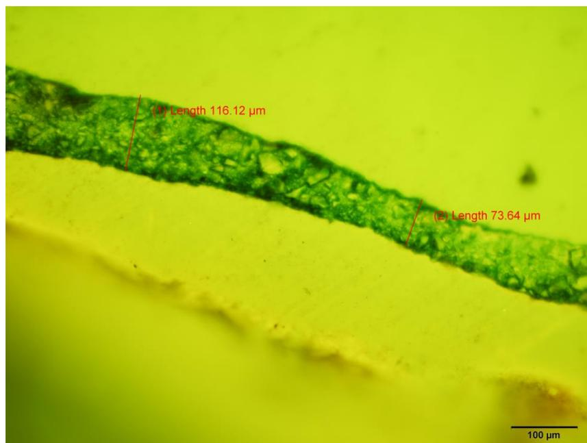
Figura No. 13. Microfotografía a 10X de microfiltración en SR Adoro.
