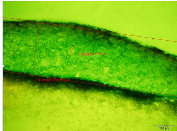
Figura No. 10. Imagen de microfiltración a 10X tamaño de la partícula del agente cementante
