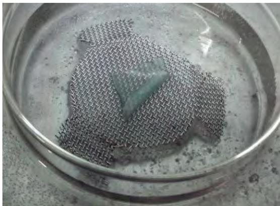
En una caja de Petri se colocó una malla del número 20, se agregó un volumen de agua destilada a temperatura ambiente hasta tocar la malla, a continuación se colocó la lámina sobre la malla y con ayuda de un cronómetro se registró el tiempo en que ya no se observaron residuos sobre la malla.
