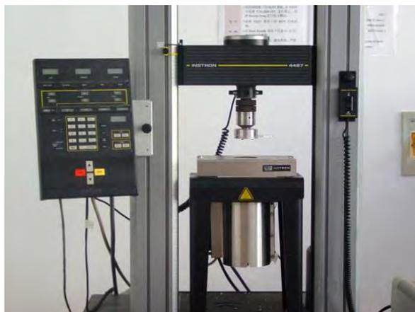
Fig. 11. Tensiómetro Instron para análisis de plásticos y películas<sup>29</sup>.
