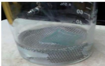
Fig. 18. Foto del dispositivo utilizado en la prueba de desintegración alternativa, con agitación magnética y lenta.
