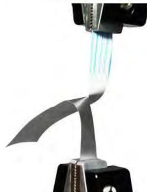
Fig. 16. Colocación de la película en las pinzas del texturómetro<sup>44</sup>.
