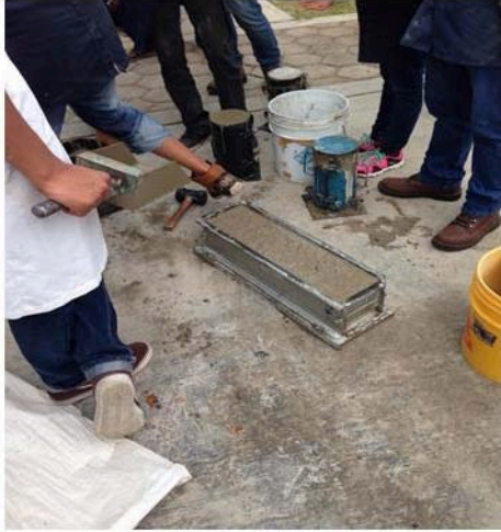
•Figura 9. Alumnos preparando probetas para pruebas de ensayo durante la realización de una practica
