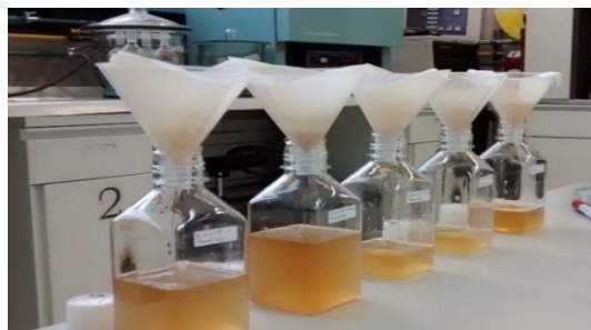
Figura 17. Filtración de mostos para su análisis
