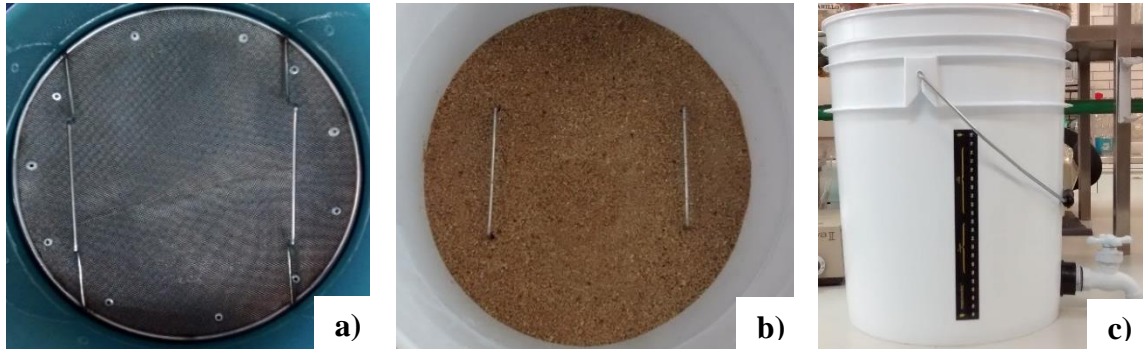
Figura 10. a) Filtro de acero inoxidable. b) Vista superior de la torta de filtración natural (bagazo). c) Bote grado alimenticio.
