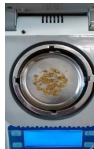
Figura 11. Prueba de humedad del bagazo
