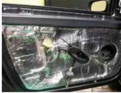
Sound Absorber de Aislante de aluminio
