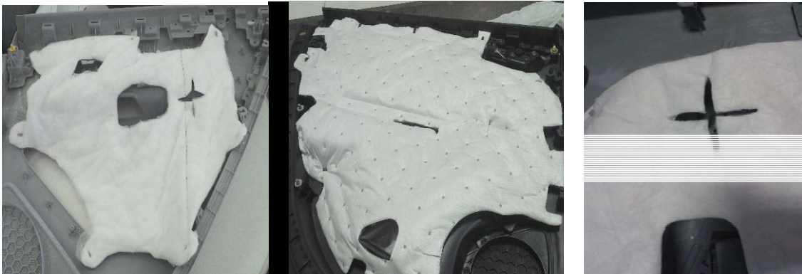
Figura 39: Modelos y prototipos – sound absorber – material original.
