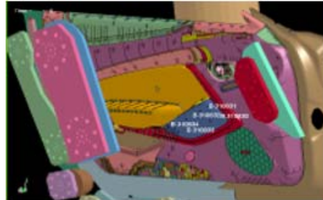
Simulación de impacto lateral (poste)
