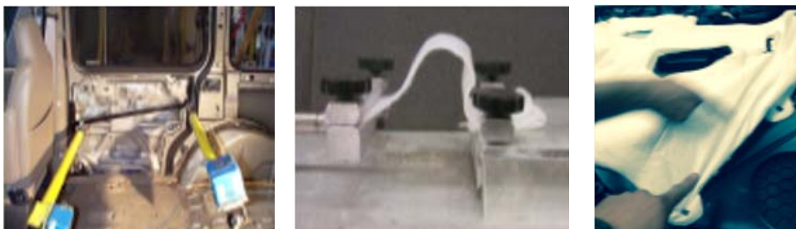
Figura 16: Pruebas físicas - Tensión - sound absorber
