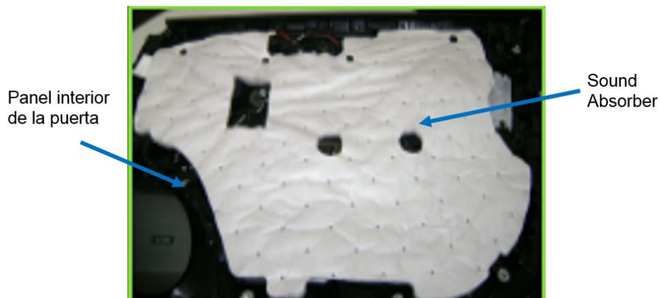
Figura 1: Ejemplo Sound Absorber
