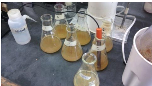
Figura A.30. Electrodo del potenciómetro Orión 720-A7
