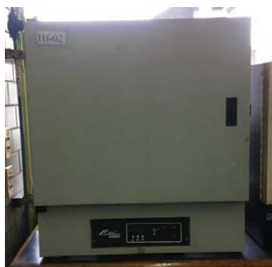
Figura A.29b. Estufa modelo Felisa-F293D empleada en la determinación del contenido de humedad en muestras
