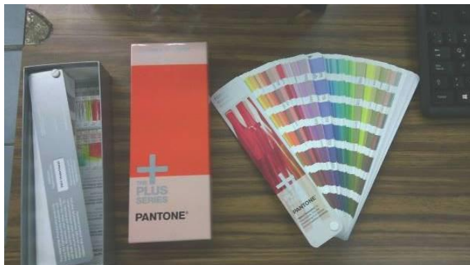
Figura A.32. Escala Pantone® usada para la determinación cualitativa del color
