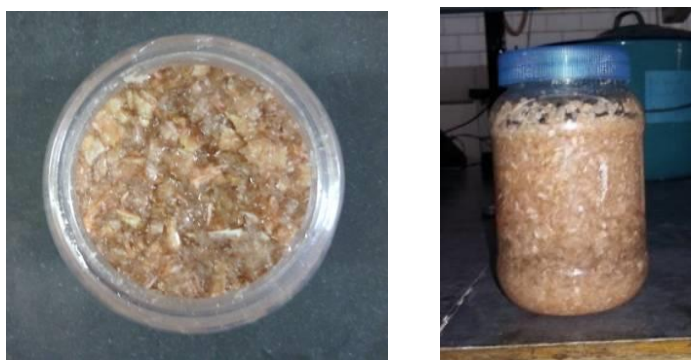
Figura A.11. Vista superior y lateral del recipiente donde se llevó a cabo la extracción de la mezcla Q-Qn del CPD con ayuda del disolvente MAC-141©
