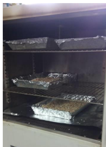
Figura A.7. Secado del CPD en horno de convección a 60°C por 18h
