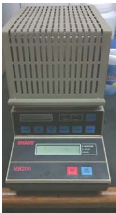
Figura A.29a. Termobalanza empleada en la determinación del contenido de humedad
