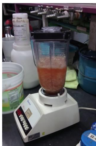
Figura A.5. Licuado del cefalotórax y los exoesqueletos limpios con agua en relación 1:2
