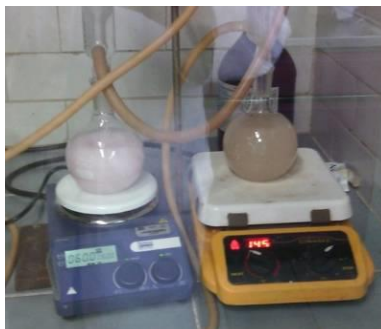
Figura A.9. Equipo de reflujo para la elaboración del disolvente MAC-141©
