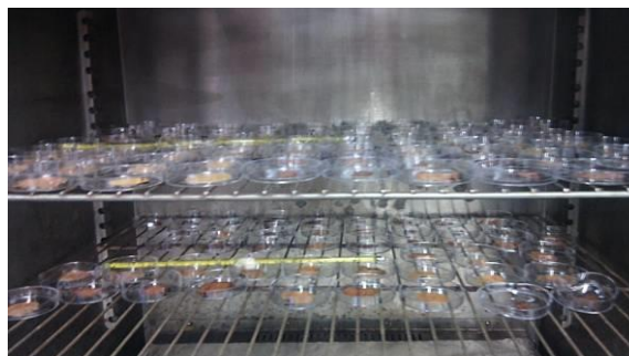
Figura A.29b. Estufa modelo Felisa-F293D empleada en la determinación del contenido de humedad en muestras
