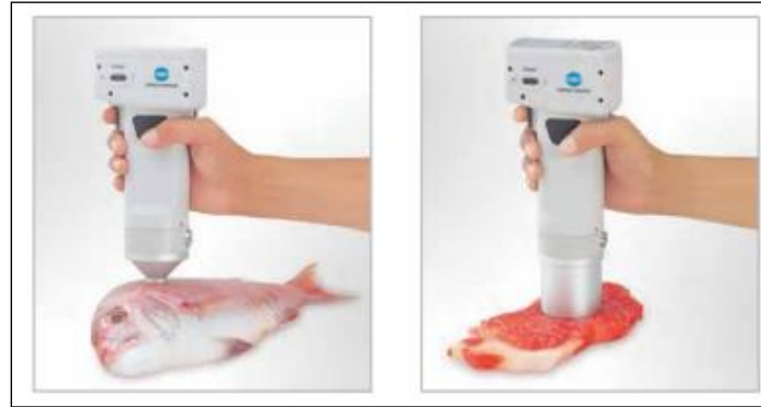
Figura 2.19. Colorímetro portátil [Tomado de Konica Minolta, 2015]
