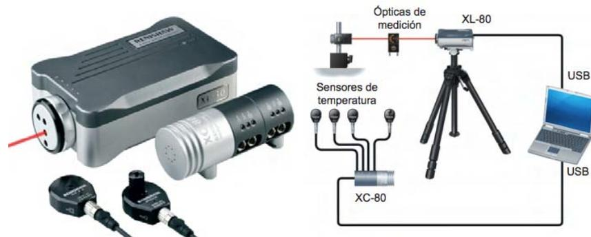
Figura 1 . 9 Equipo de calibración *Renishaw* modelo XL-80
