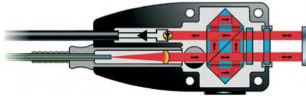
Figura 1 . 11 Trayectoria óptica dentro del cabezal *Renishaw* (Renishaw, 2012)
