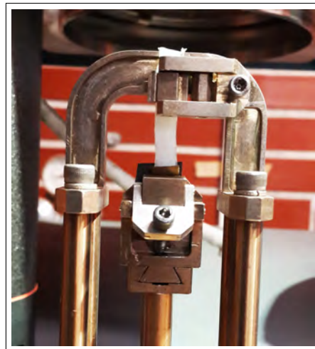
Figura 2.4: Montaje experimental usado para medir las propiedades mecánicas del cartilago traqueal.
