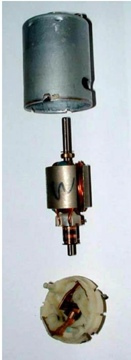
Fig. 3.14 Composición de un Motor con escobillas
