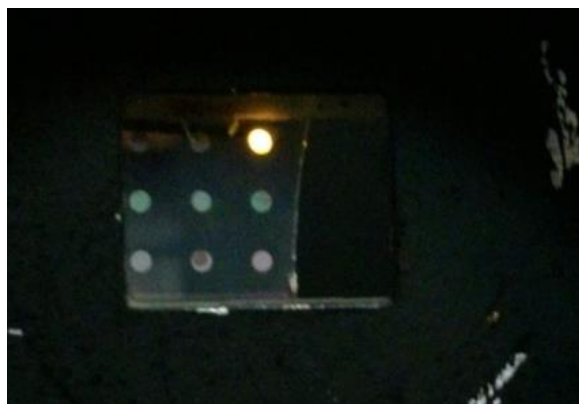
Figura 55. Estructura electroluminiscente en funcionamiento, se destaca que la luz emitida es observable en condiciones de luz ambiente.
