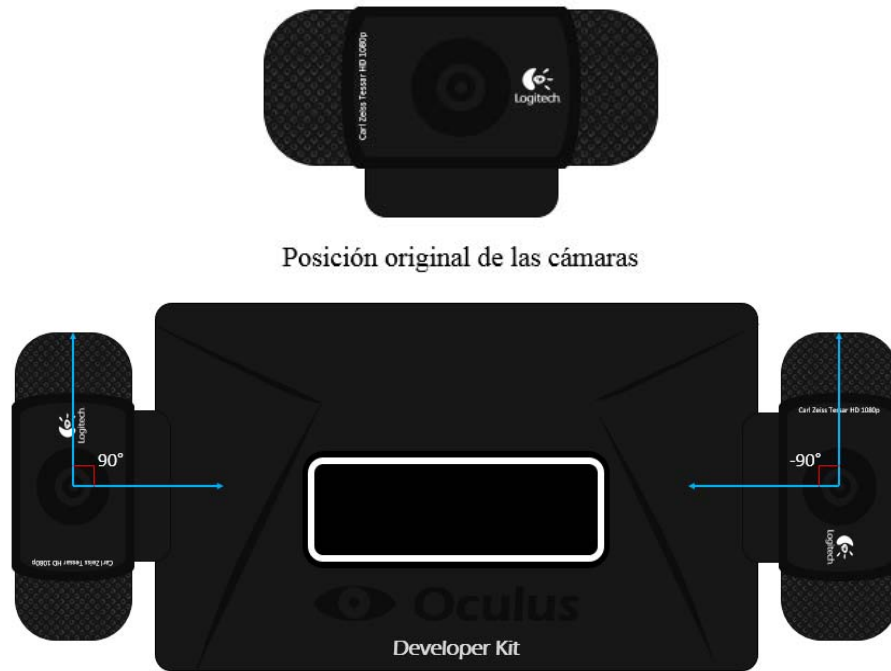
Figura 21. Colocación de las cámaras en el sistema de Realidad Aumentada.
