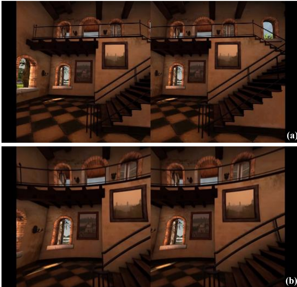
Figura 33. Despliegue de una escena sobre la pantalla del casco de Realidad Virtual, sin distorsión (a) y con distorsión ocasionada por los lentes (b).
