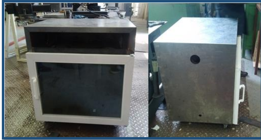
Figura 41. Ensamble con láminas exteriores y puerta.
