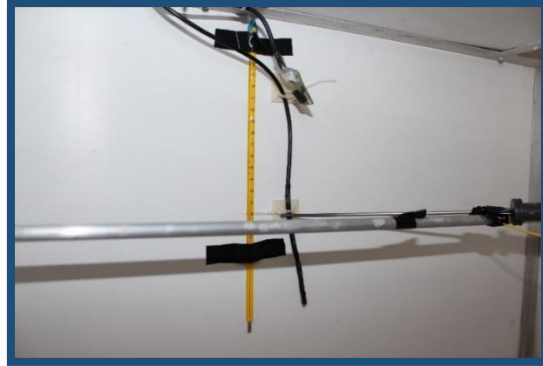
Figura 34. Colación de sensores al interior de la cámara de incubación
